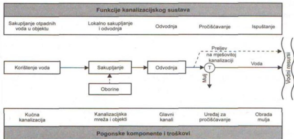
**SLIKA 5.** Općeniti prikaz odvodnog sustava
