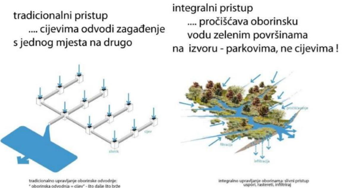
**SLIKA 6.** Konvencionalni i zeleni-integralni koncept odvodnje oborinskih voda
