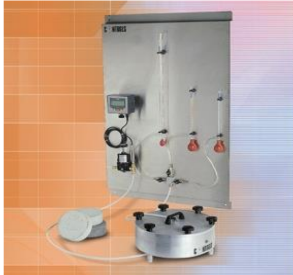
Slika 5.3 Uređaj za ispitivanje plino-propusnosti betona
