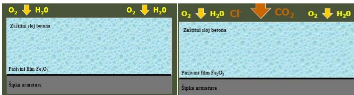
Slika 2.7 Pasivizacija (lijevo), Depasivizacija (desno)
