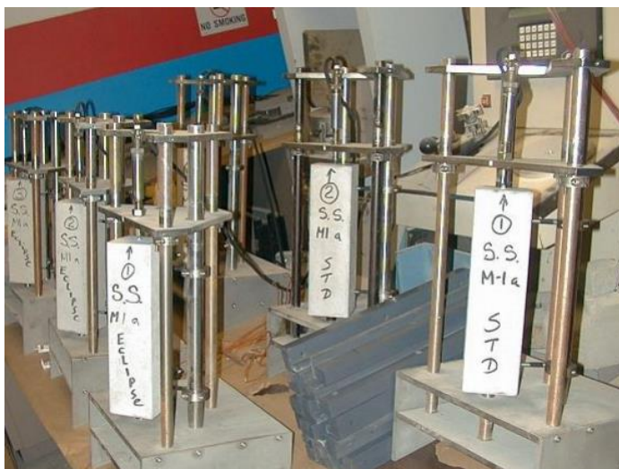
Slika 26. Prikaz više istovremenih testova skupljanja koristeći LVDT [12]
