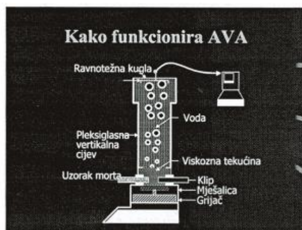
Slika 5.5 Shematski prikaz djelovanja analizatora zračnih pora [7]
