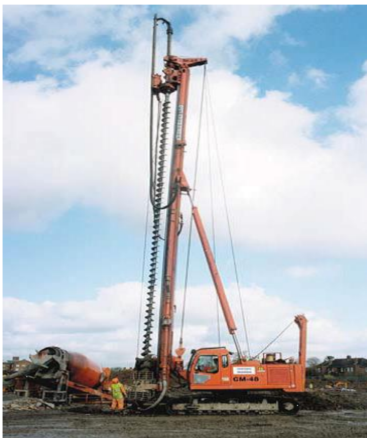
Slika 1. Bušća garnitura za CFA pilote
