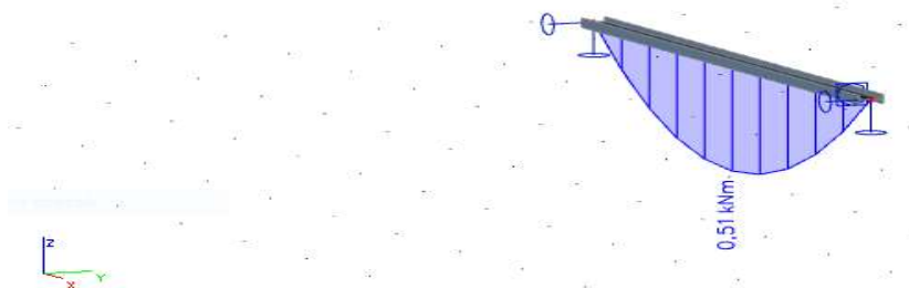
Slika 45 Momentni dijagram M_z za mjerodavnu kombinaciju
