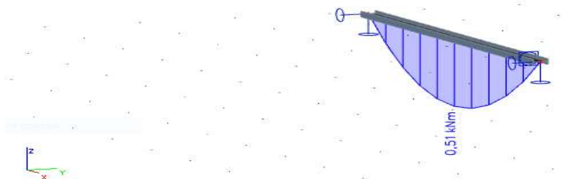
Slika 45 Momentni dijagram M_z za mjerodavnu kombinaciju
