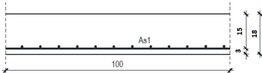
Slika 10.3. Poprečni presjek ploče stubišta
