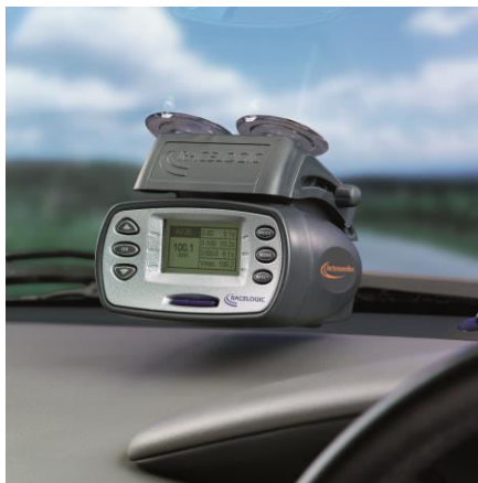
Slika 4.1 GPS uređaj PerformanceBox [124]
