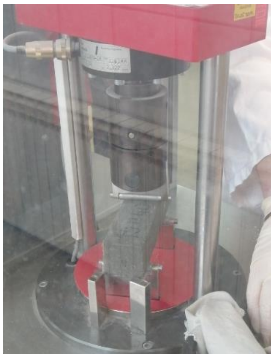
Slika 49. Ispitivanje čvrstoće na vlak (savijanjem)
