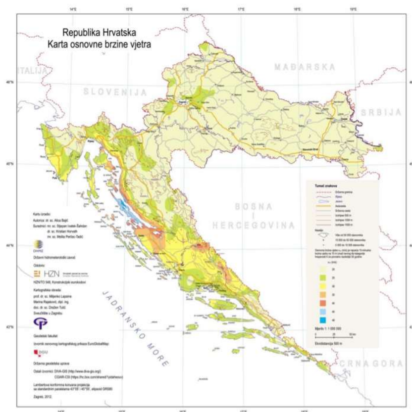
Slika 8.7. Karta osnovnih brzina vjetra v_{b,0}
