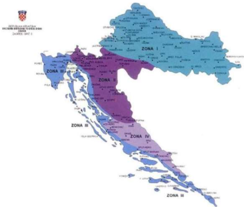
Slika 8.6. Klimatske zone karakterističnog opterećenja snijegom s_k (kN/m 2 )
