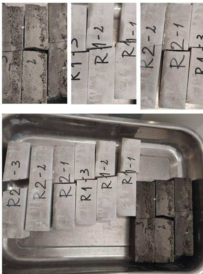
Slika 35. Referentni mort 1, R1 i R2 nakon savijanja
