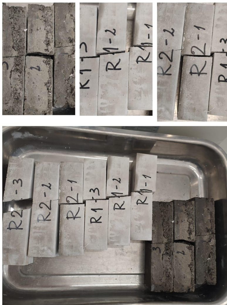
Slika 35. Referentni mort 1, R1 i R2 nakon savijanja
