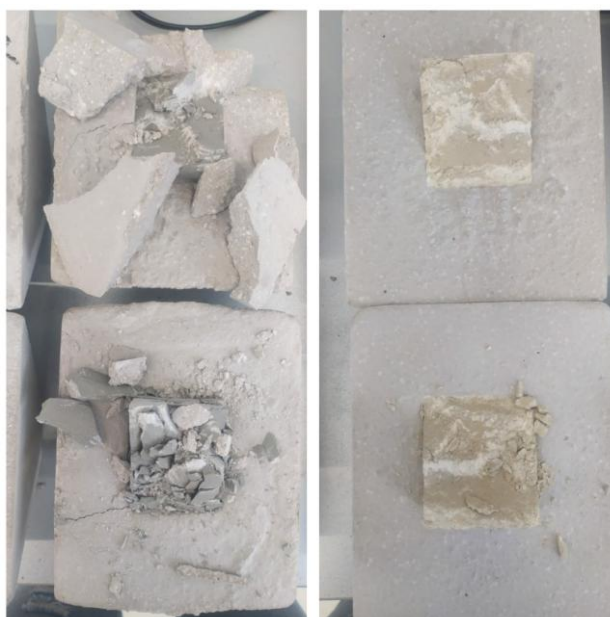
Slika 40. Uzorci 18/20 i 08/19 imobilizirani mortom recepture 3
