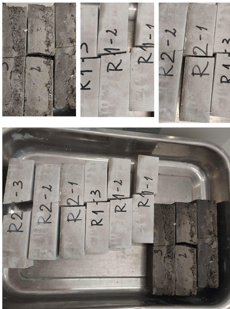
Slika 35. Referentni mort 1, R1 i R2 nakon savijanja
