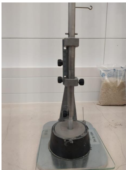
Slika 10. Ispitivanje standardne konzistencije Vicatovim aparatom
