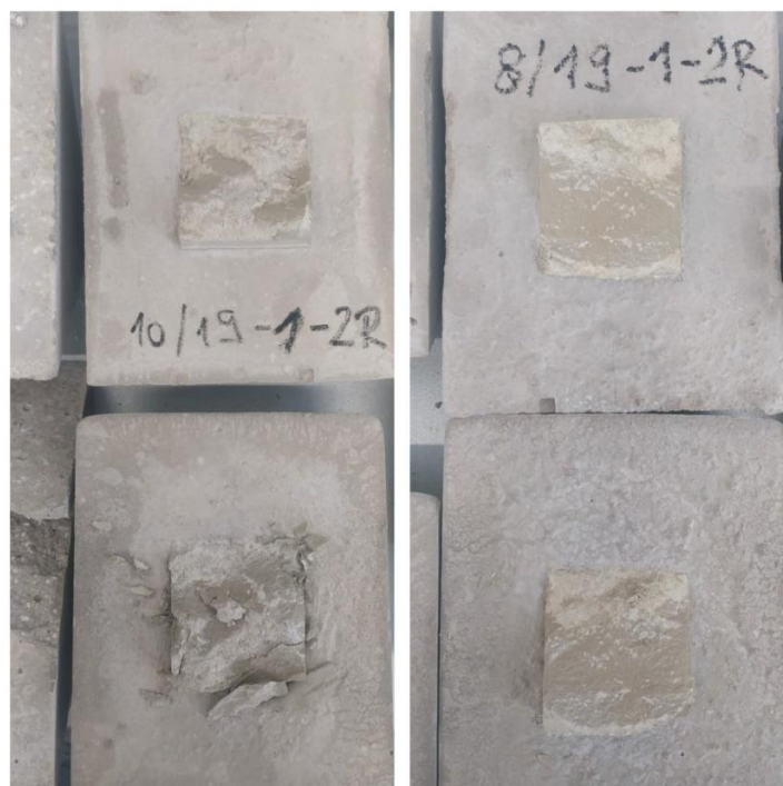
Slika 39. Uzorci 10/19 i 08/19 imobilizirani mortom recepture 2
