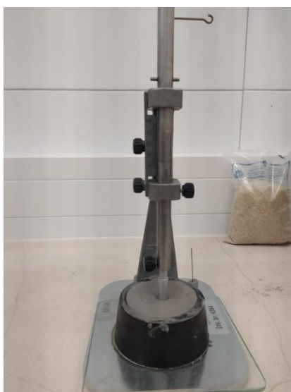
Slika 10. Ispitivanje standardne konzistencije Vicatovim aparatom
