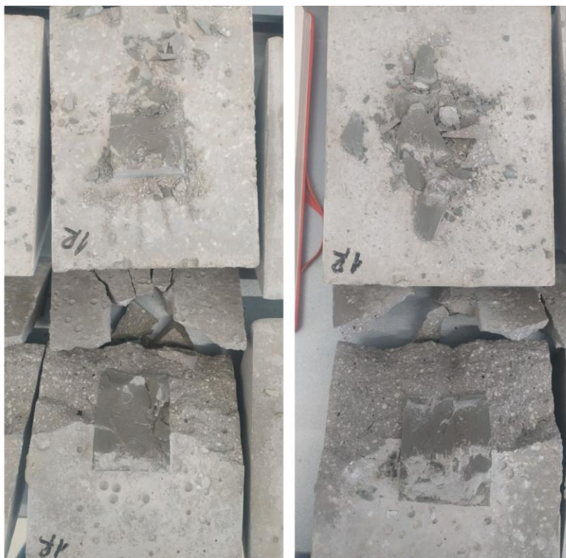
Slika 37. Uzorci 18/20 imobilizirani mortom recepture 1
