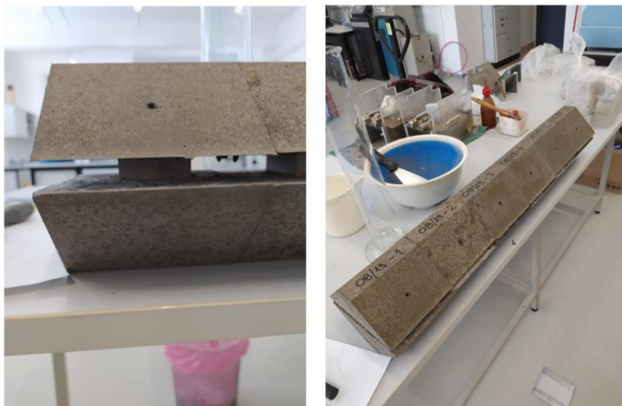
Slika 7. Uzorci spremni za smicanje
