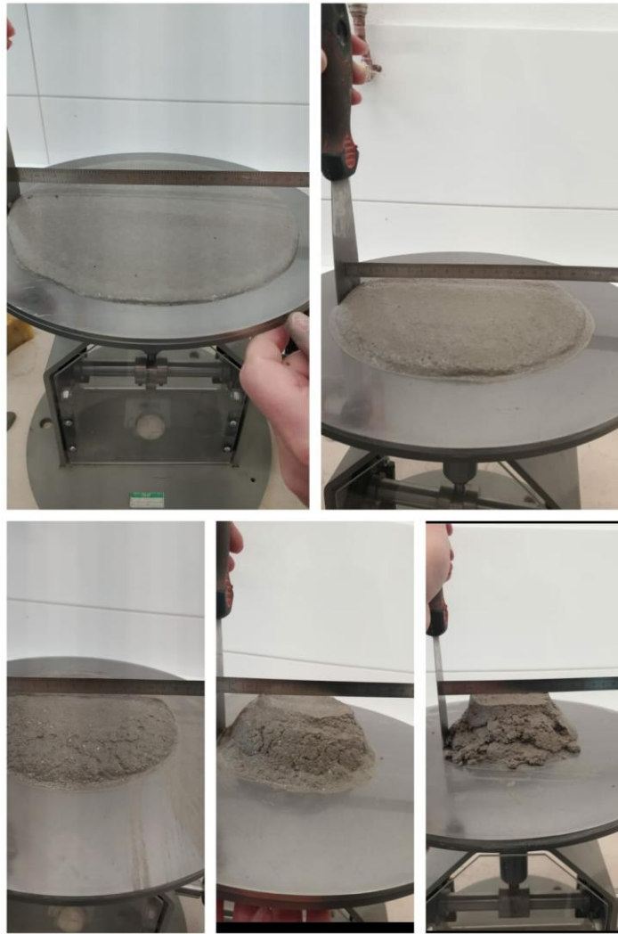
Slika 25. Ispitivanje obradljivosti morta
