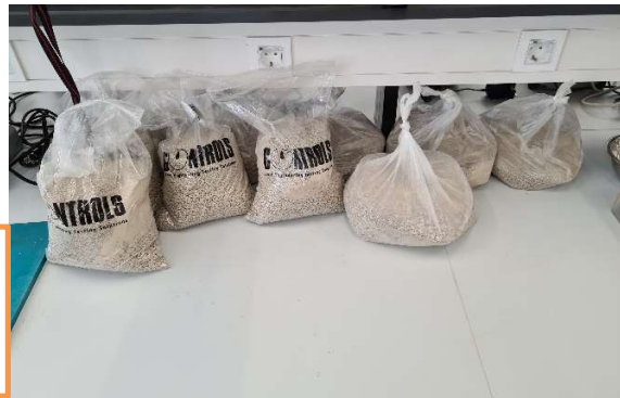
Slika 4.3 Uzorci jednakih masa prije dodavanja vode
