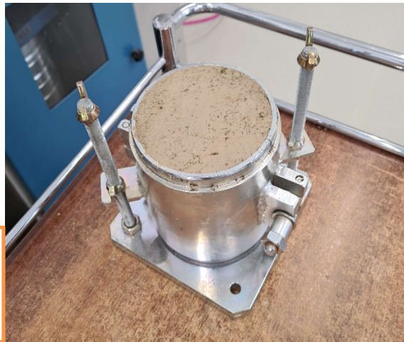
Slika 4.6 Uzorak spreman za konačno vaganje
