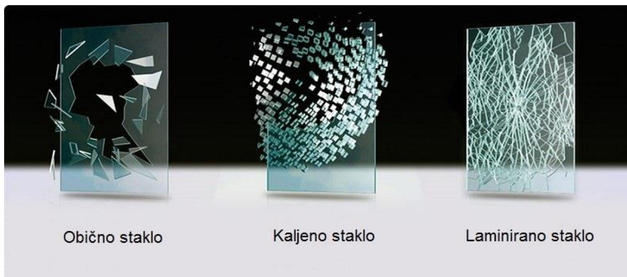
Slika 8. Prikaz loma običnog, kaljenog i laminiranog stakla
