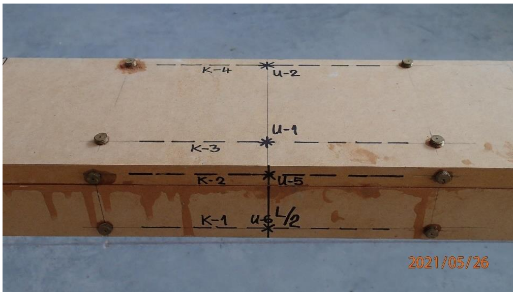
Slika 37: Položaj markica na grednom nosaču
