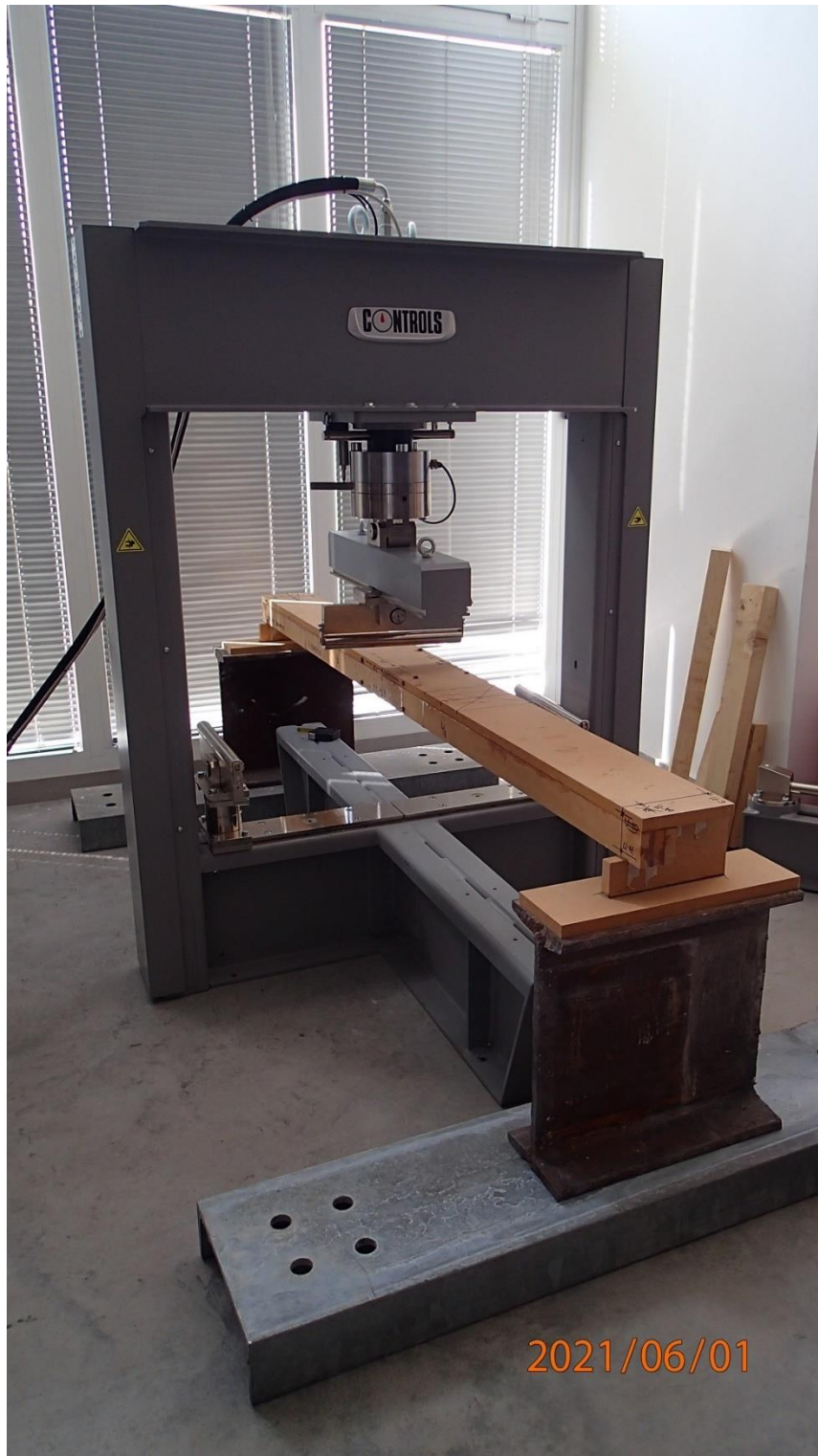
Slika 57: Priprema grednog nosača za ispitivanje na uređaju AUTOMAX MULTITEST Computerized Control Console
