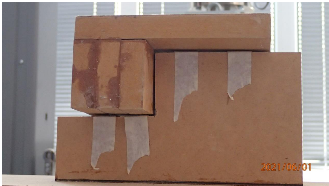
Slika 62: Odizanje poprečnog presjeka kod ležaja
