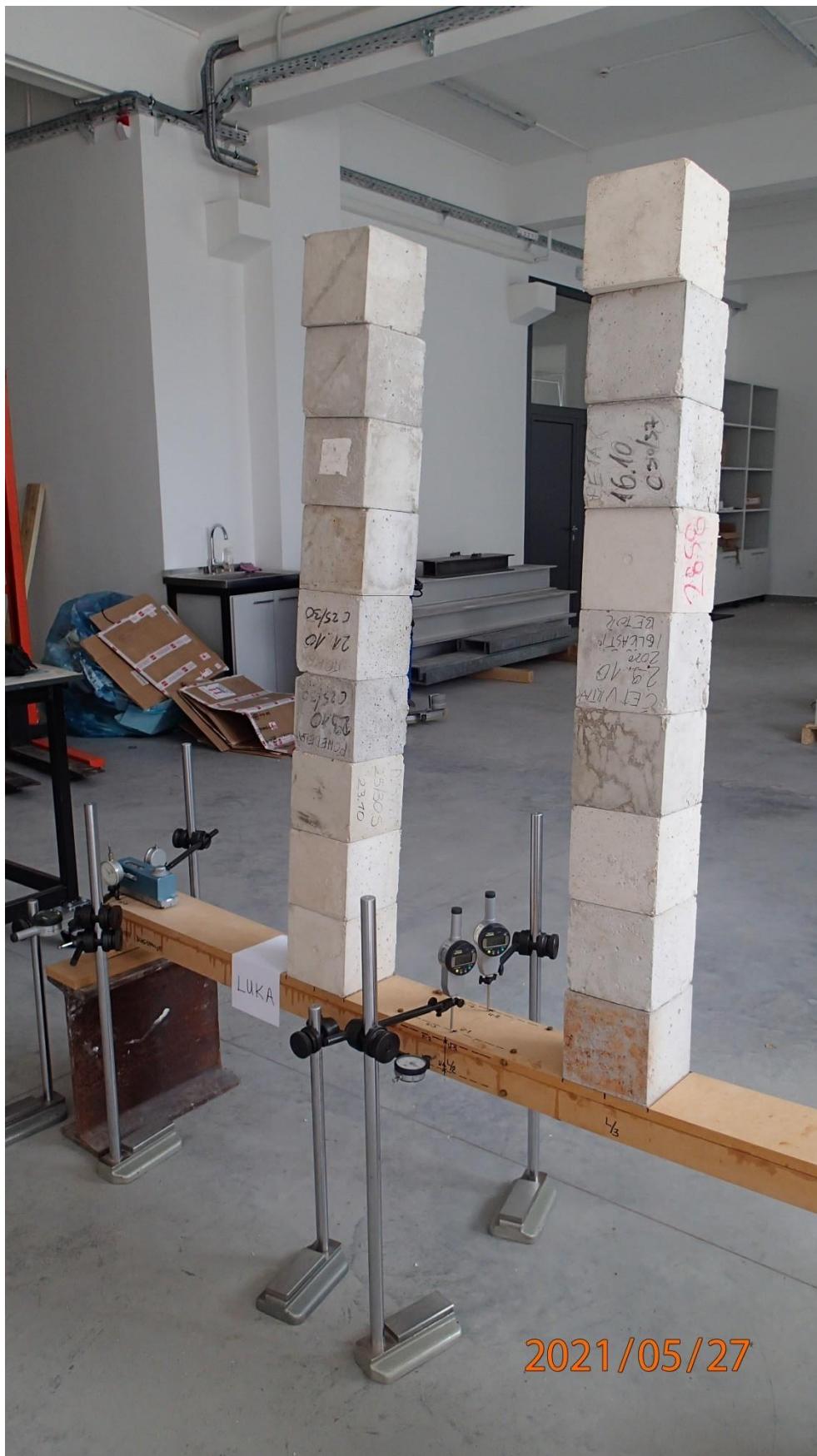
Slika 52: Nosač s devet redova opterećenja, F = 0,72 kN
