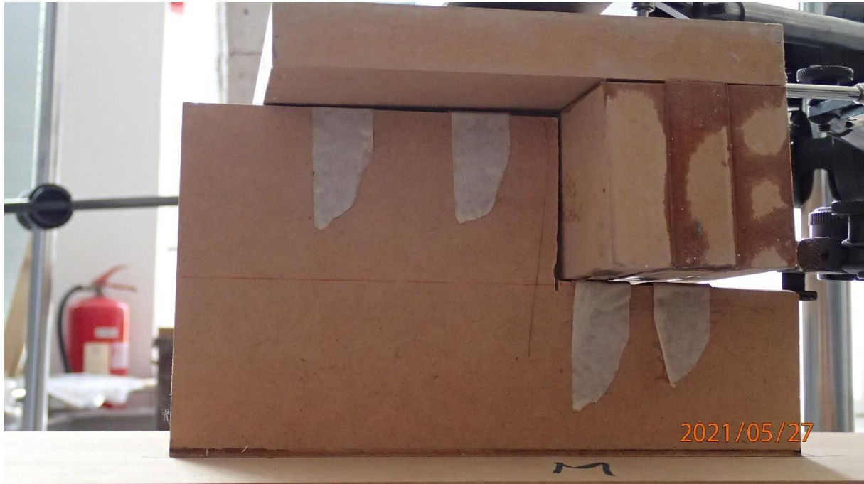
Slika 53: Prikaz odizanja i rotacije poprečnog presjeka kod ležaja
