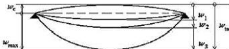
Slika 45. Prikaz progiba ploče
