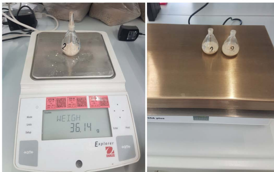
Slika 4. Prikaz ispitivanja gustoće čvrstih čestica metodom piknometra
