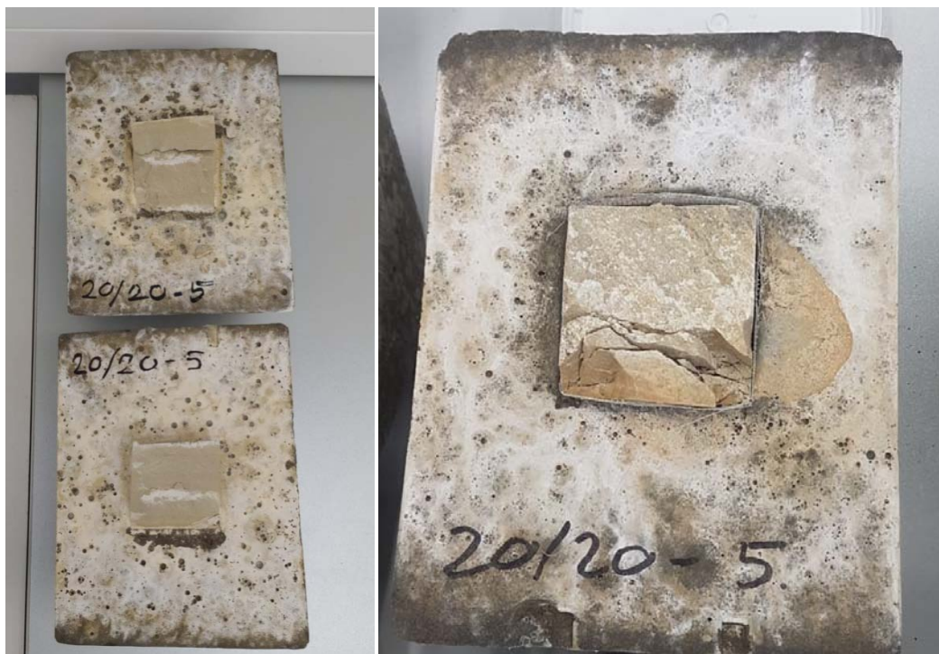
Slika 17. Prikaz uzoraka nakon pokusa izravno posmika a) bez mrežice b) s mrežicom
