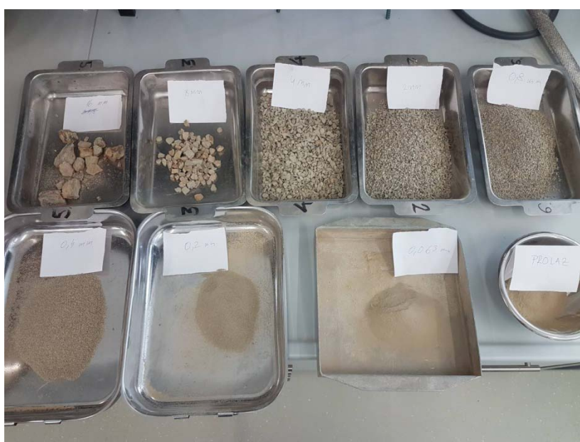
Slika 11. Podjela uzoraka u frakcije
