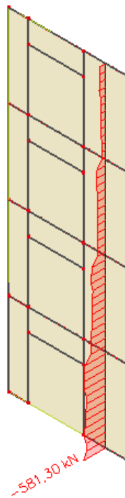
Slika 150. Uzdužne sile u zidu Zy1 (kN)
