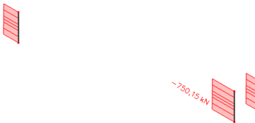
Slika 127. Prikaz maksimalne uzdužne sile na stupovima S2 (kN)
