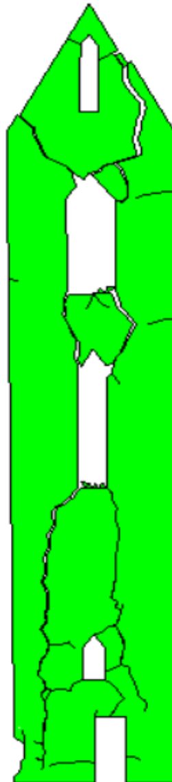
Slika 6.12. Prikaz trenutka urušavanja reprezentativnog modela zvonika.
