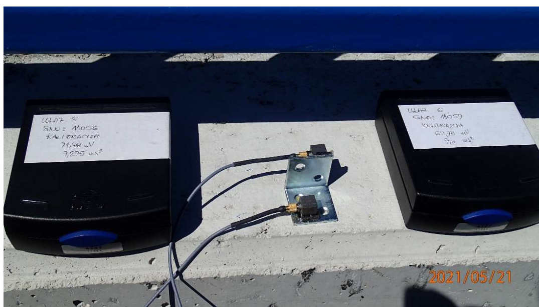
Slika 4.14. Jednoosni akcelerometri za mjerenje dinamičkih veličina
