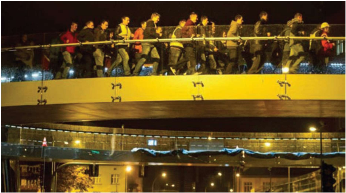
Slika 2.4. Dinamičko ispitivanje – ljudska navala-sporo trčanje [4]
