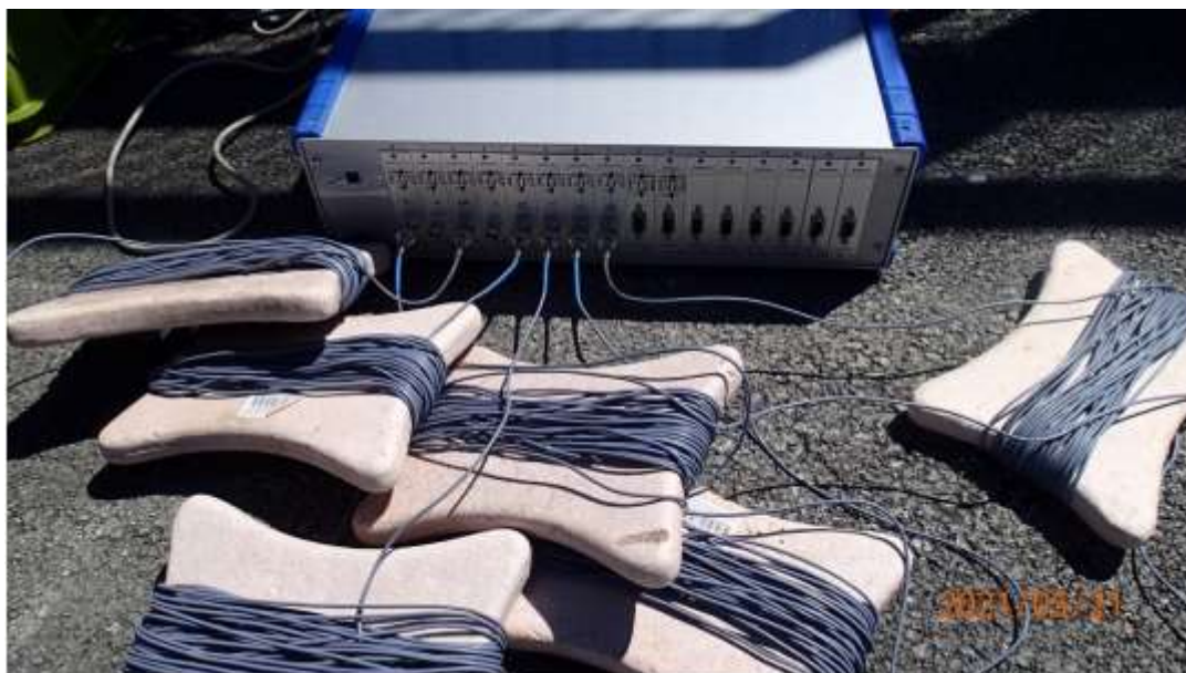
Slika 4.13. Uređaj za dinamička mjerenja DEWETRON 2010 odnosno DEWE-Rack
