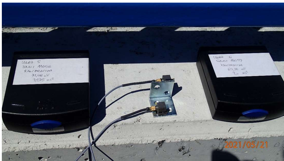
Slika 4.14. Jednoosni akcelometri za mjerenje dinamičkih veličina
