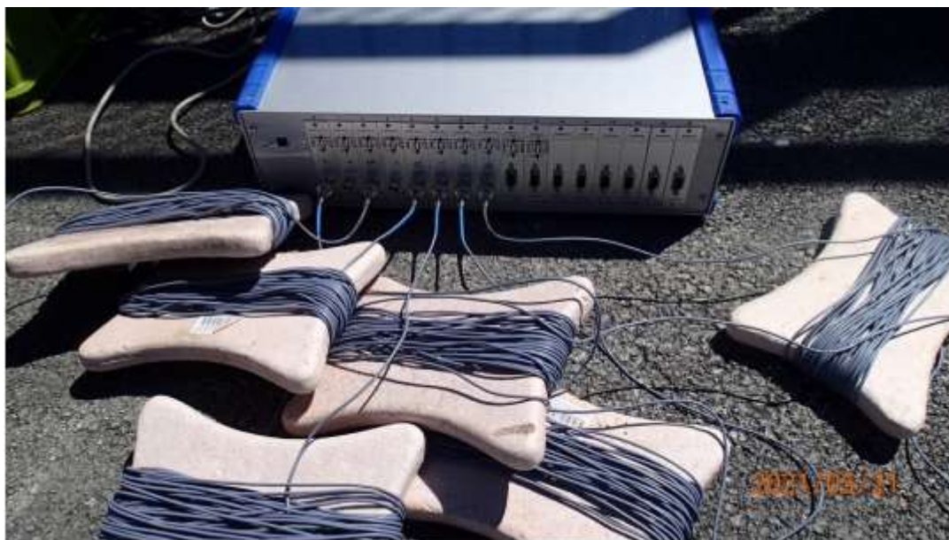
Slika 4.13. Uređaj za dinamička mjerenja DEWETRON 2010 odnosno DEWE-Rack
