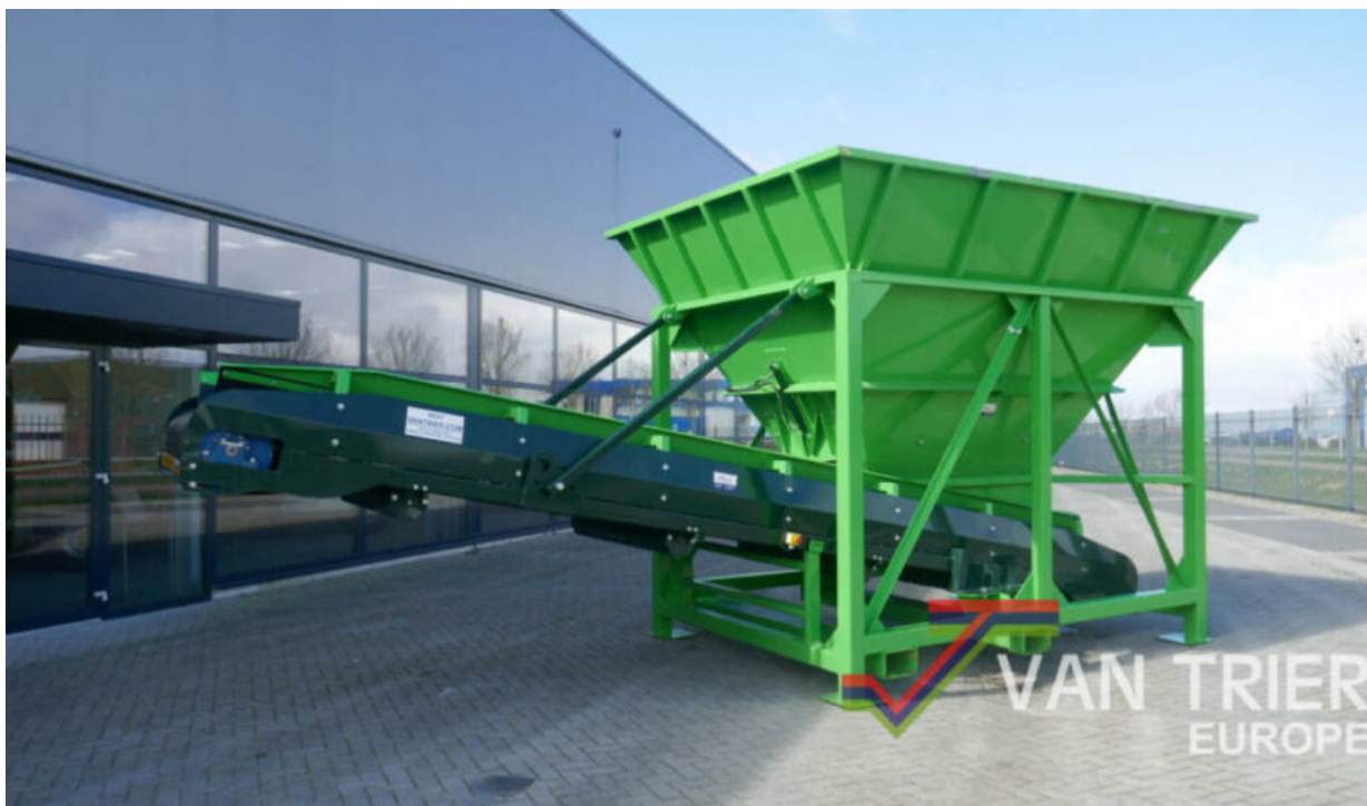
Slika 2.7 Transportna traka Hopper TR 38/28 [18]
