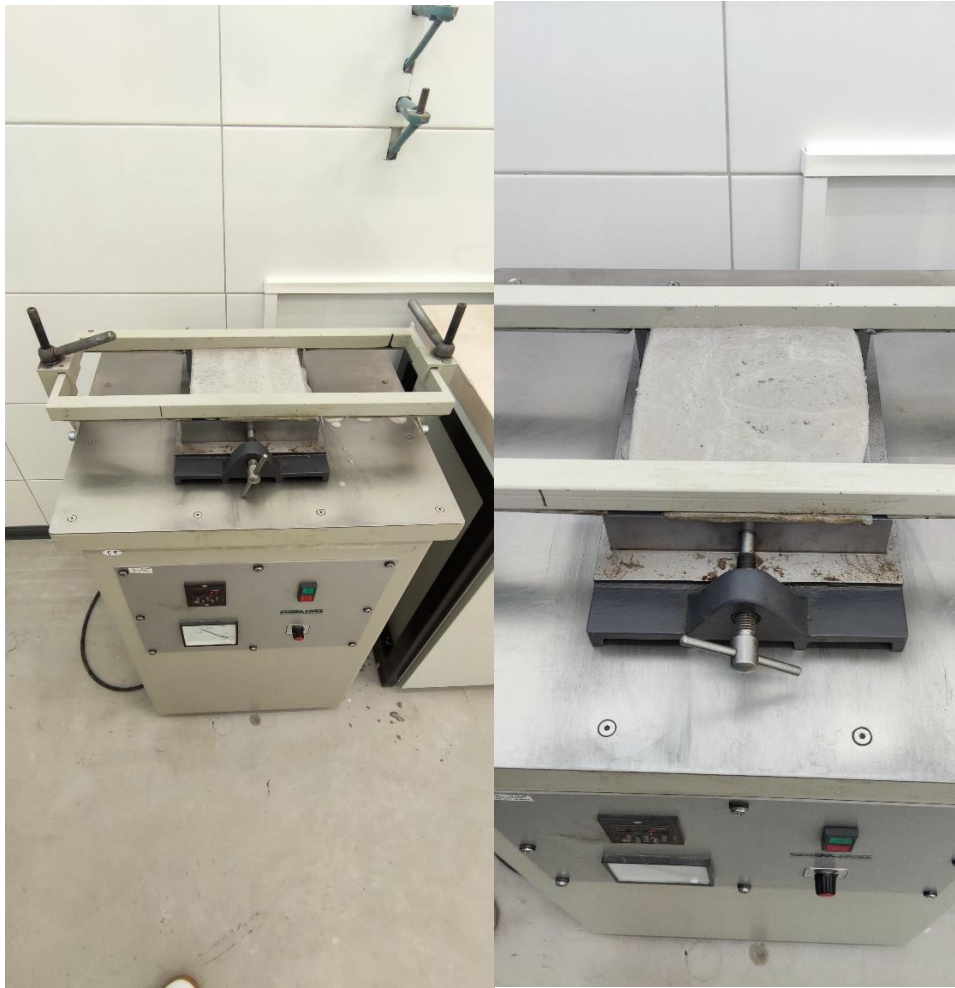
Slika 18, Ugradnja morta u kalupe [slika iz laboratorija]
