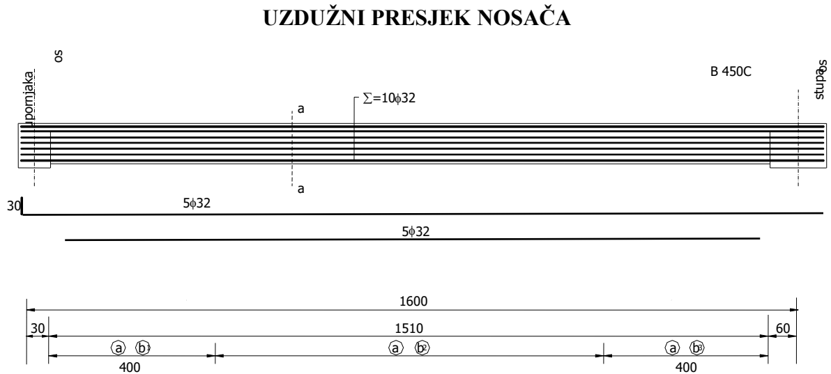
Slika 32. Prikaz armiranja uzduznog nosača u polju
