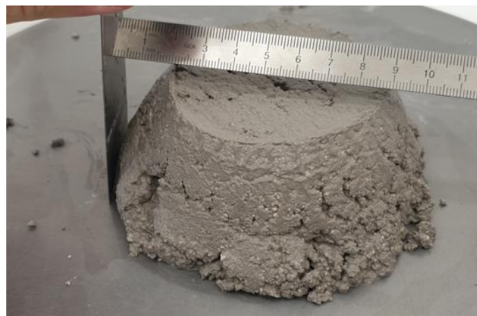
Slika 47. Obradljivost uzorka T2
