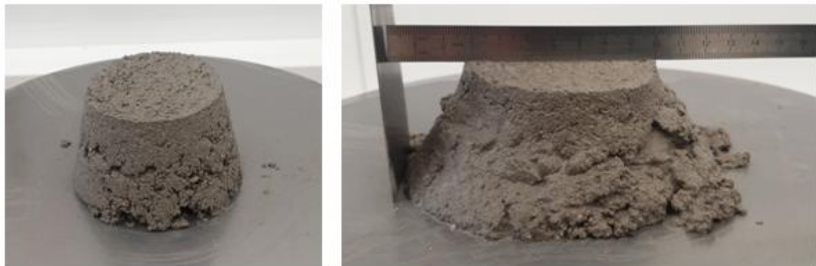
Slika 34. Obradljivost uzorka L4
