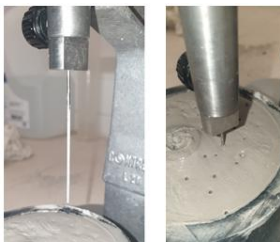
Slika 27. Ispitivanje vremena vezanja paste Vicatovom iglom
