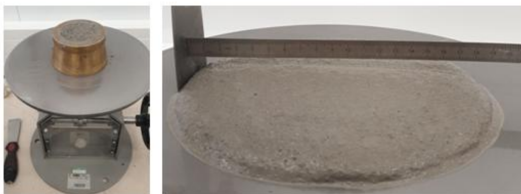
Slika 31. Obradljivost uzorka L1
