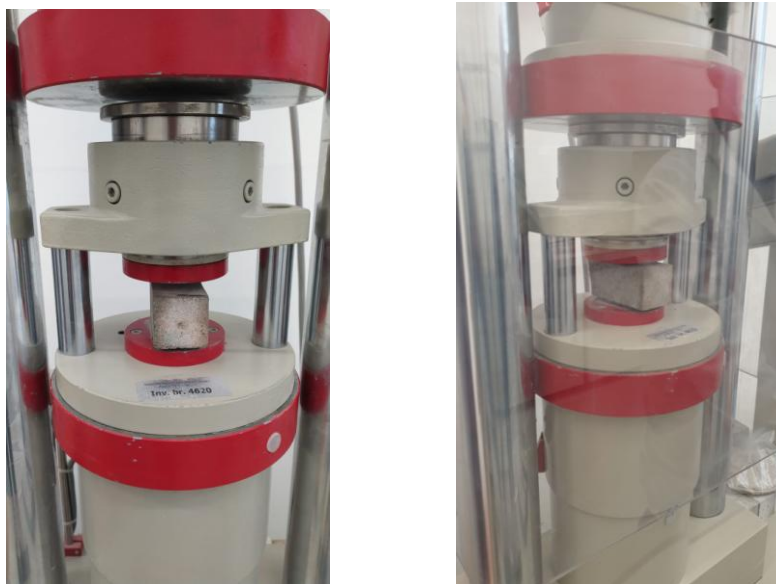
Slika 21. Uređaj za ispitivanje tlačne čvrstoće
