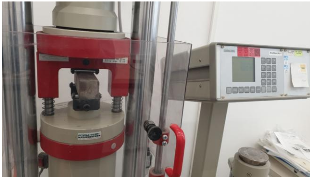
Slika 19. Uređaj za ispitivanje savojne čvrstoće
