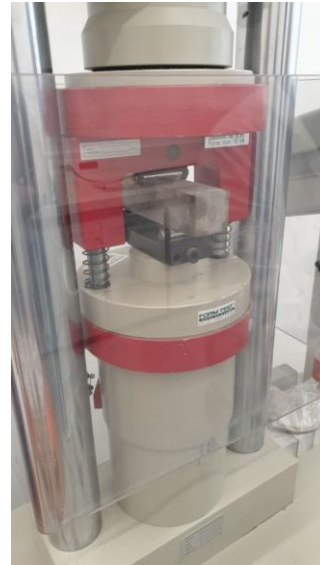
Slika 19. Uređaj za ispitivanje savojne čvrstoće
