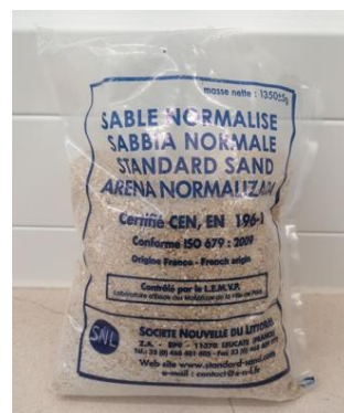
Slika 6. Standardni pijesak CEN (ISO standardni pijesak)
