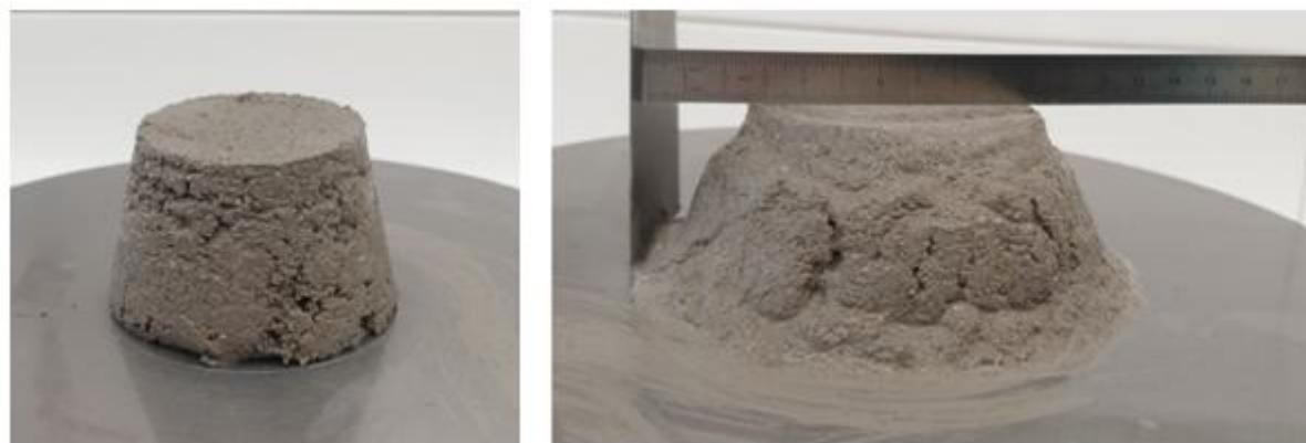
Slika 33. Obradljivost uzorka L3
