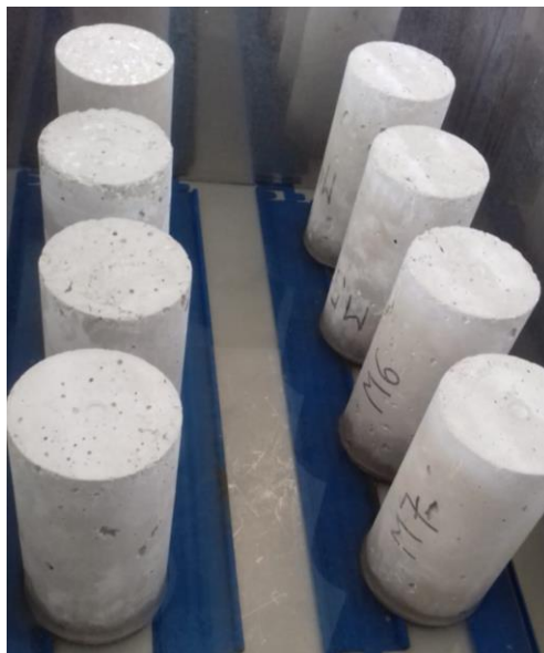
Slika 47 Primjer ispitivanja vodoupojnosti
