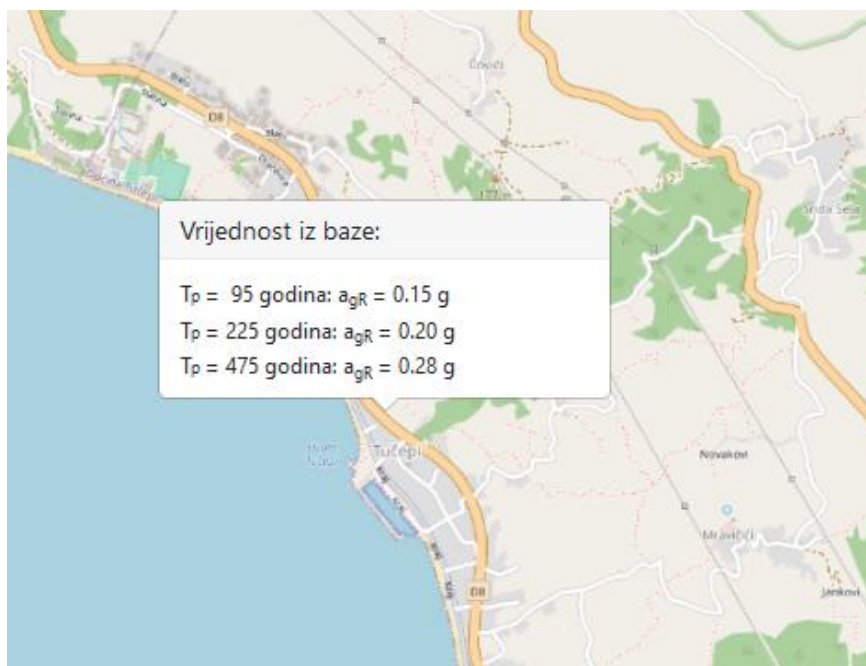
Slika 8. Parametar vršnog ubrzanja tla za promatranu lokaciju
