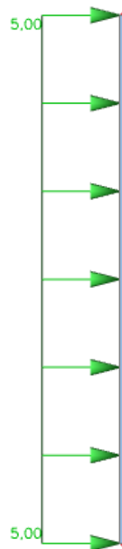
Slika 120. Korisno opterećenje na zid bazena
