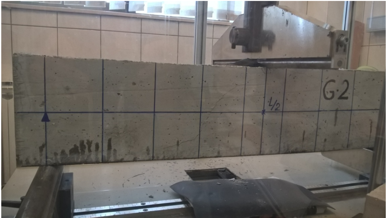
Fotografija 4.12: Pojava pukotina na gredi G2 (ojačana karbonskom trakom)
