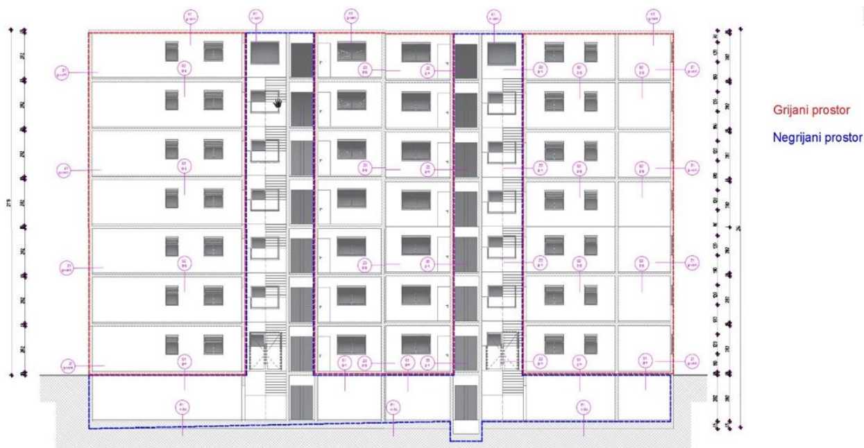
Slika 81. Presjek zgrade sa ucrtanom granicom grijanog/negrijanog prostora
