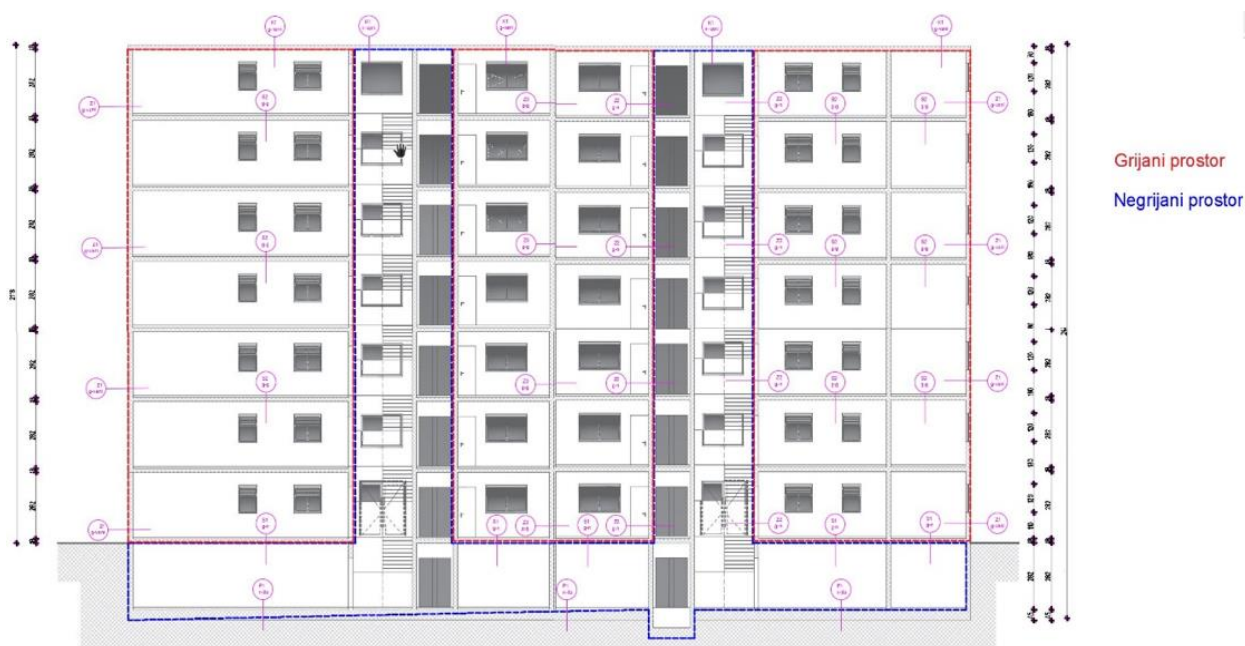
Slika 81. Presjek zgrade sa ucrtanom granicom grijanog/negrijanog prostora
