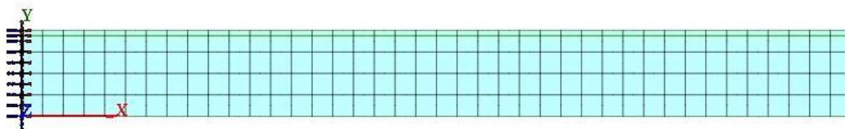
Slika 53: Prikaz diskretizacije numeričkog modela i rubnih uvjeta (Midas FEA)
