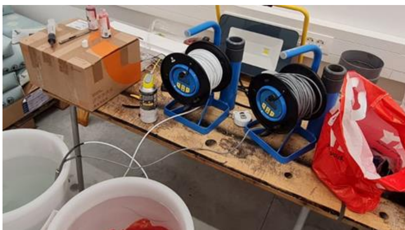
Slika 6 Multi - senzorska sonda za mjerenje parametara vode
