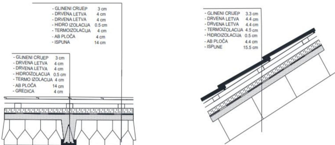
Slika 2.4 Presjek krovne ploče – prikaz slojeva
