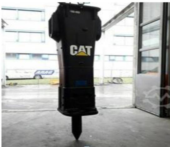
Slika 4.10. Pneumatski čekić,Caterpillar
