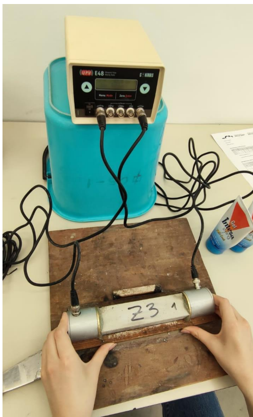
Slika 15, Ispitivanje brzine ultrazvuka [slika zabilježena tijekom ispitivanja]
