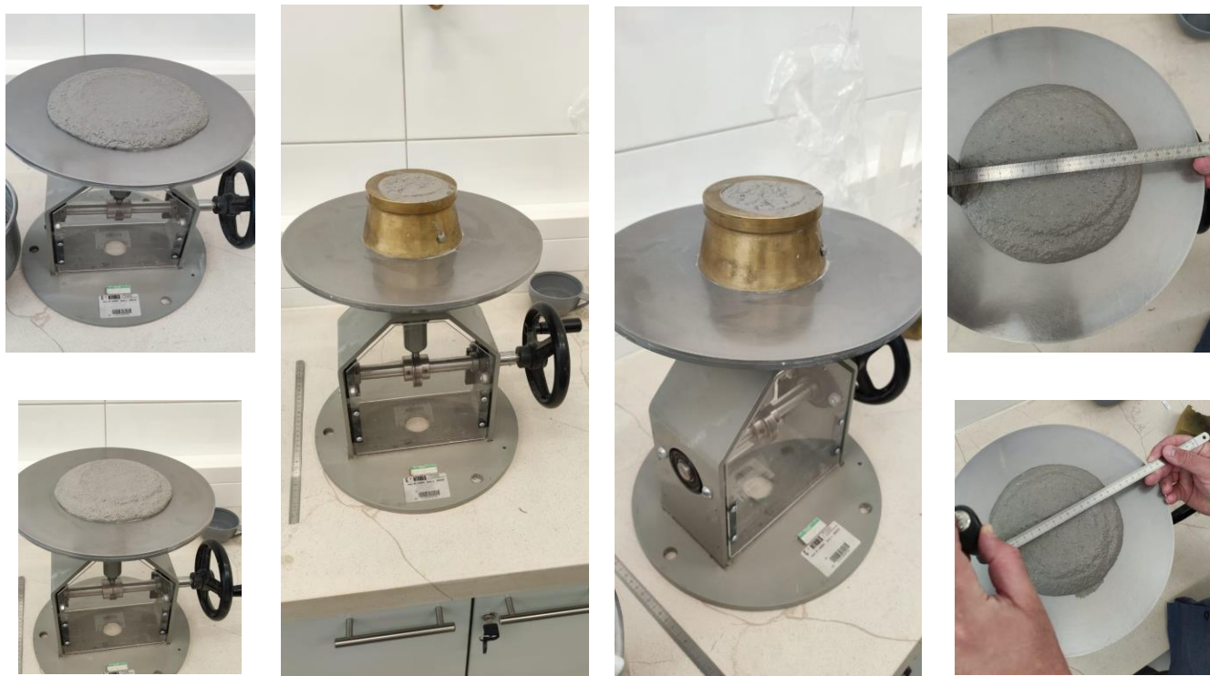
Slika 11, Ispitivanje obradivosti [Slike zabilježene tijekom ispitivanja]
