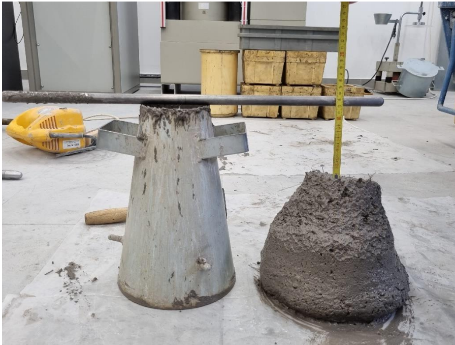
Slika 5.3: Mjerenje slijeganja za mješavinu PP
