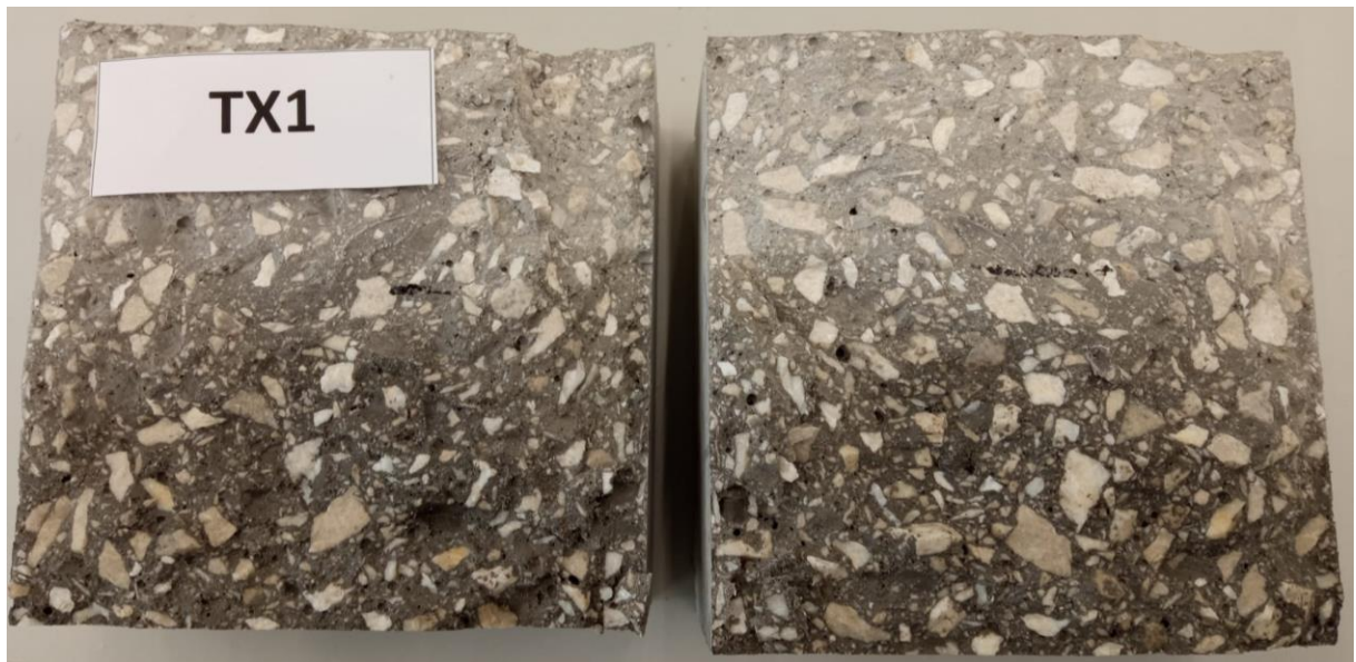
Slika 5.37: Detalj prodora vode u uzorak TX1.7
