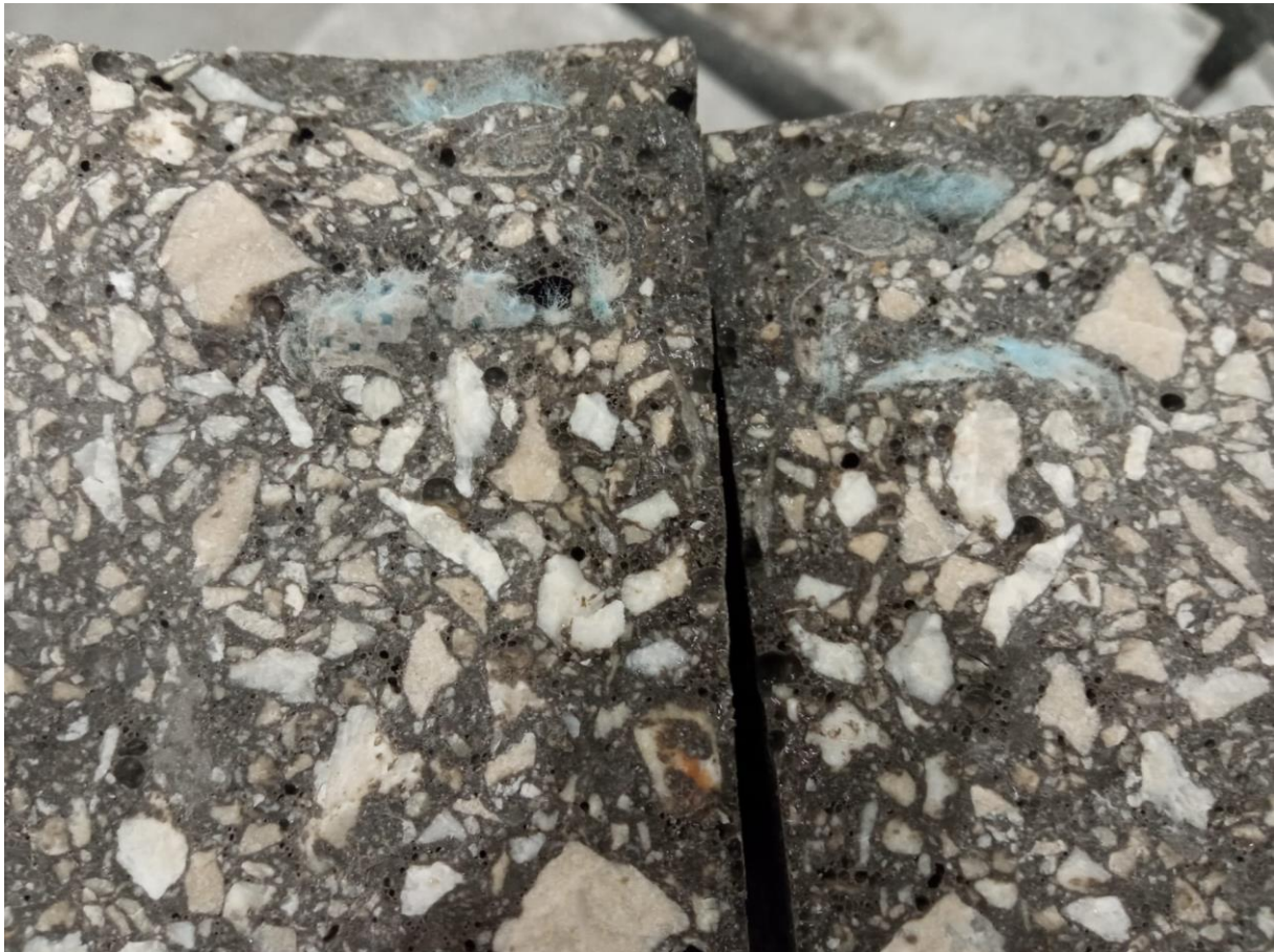
Slika 5.19: Detalj loma uzorka M1.0 nastalog savijanjem
