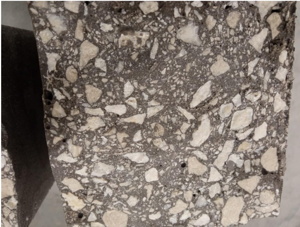
Slika 5.16: Lom uzorka TX1.7 nastao savijanjem
