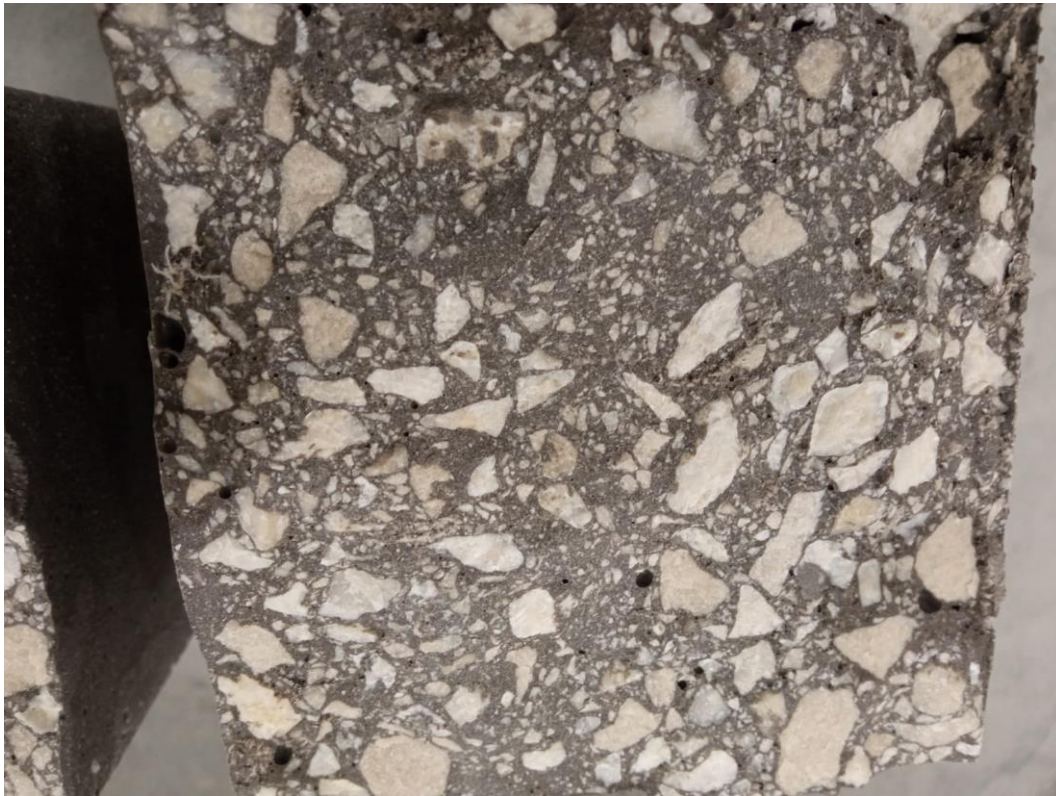
Slika 5.16: Lom uzorka TX1.7 nastao savijanjem
