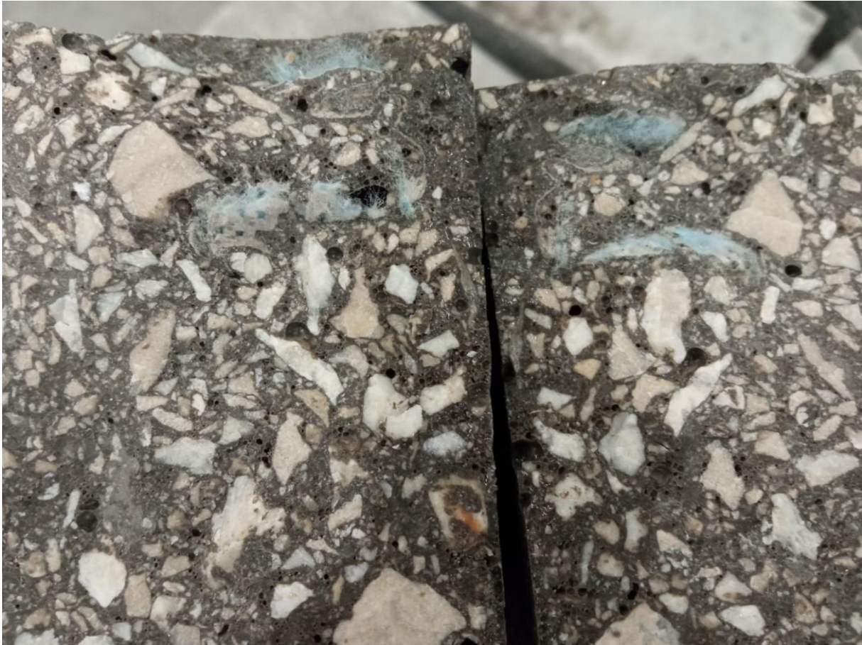
Slika 5.19: Detalj loma uzorka M1.0 nastalog savijanjem
