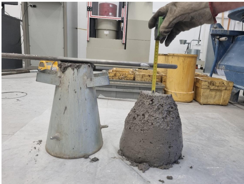
Slika 5.5: Mjerenje slijeganja za mješavinu M0.75
