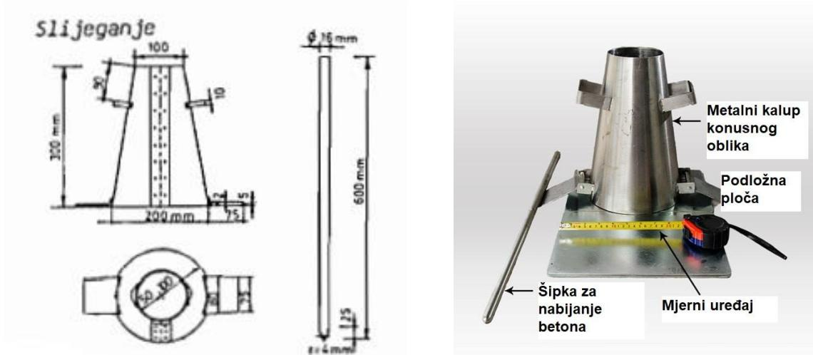
Slika 3.1. Oprema za ispitivanje slijeganja betona [2]
