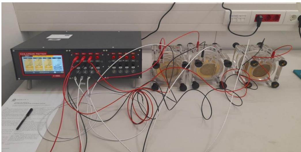
Slika 3.13. Uredaj za ispitivanje uzorka na kloride
