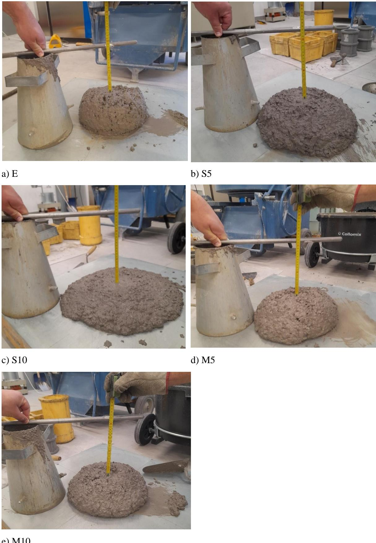
Slika 4.4. Ispitivanje slijeganja mješavina
