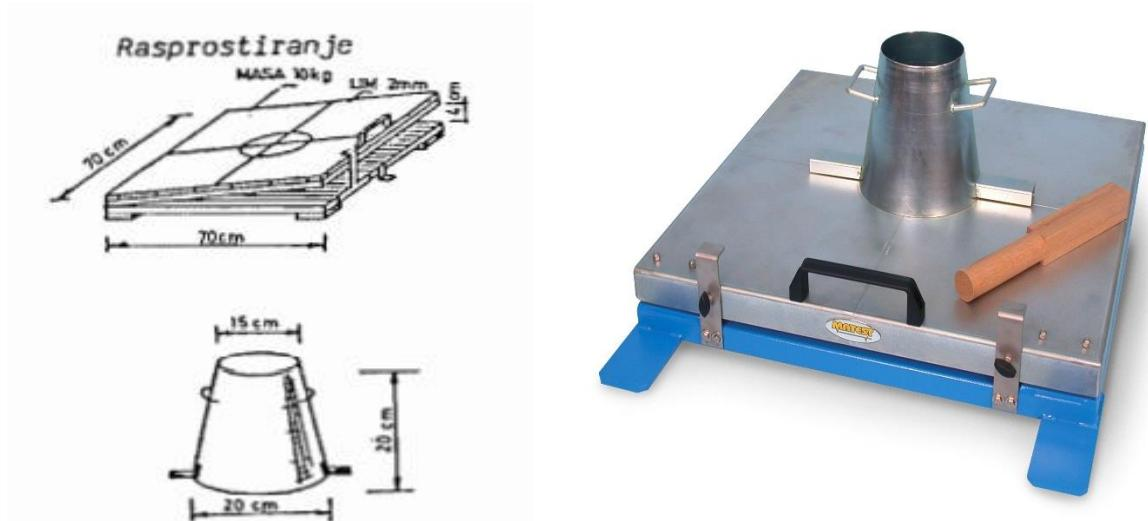
Slika 3.2. Oprema za ispitivanje rasprostiranja betona [2]
