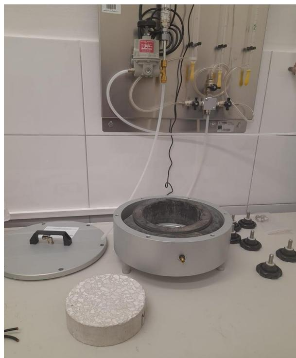
Slika 3.9. Uredaj i ispitni uzorak za ispitivanje plinopropusnosti
