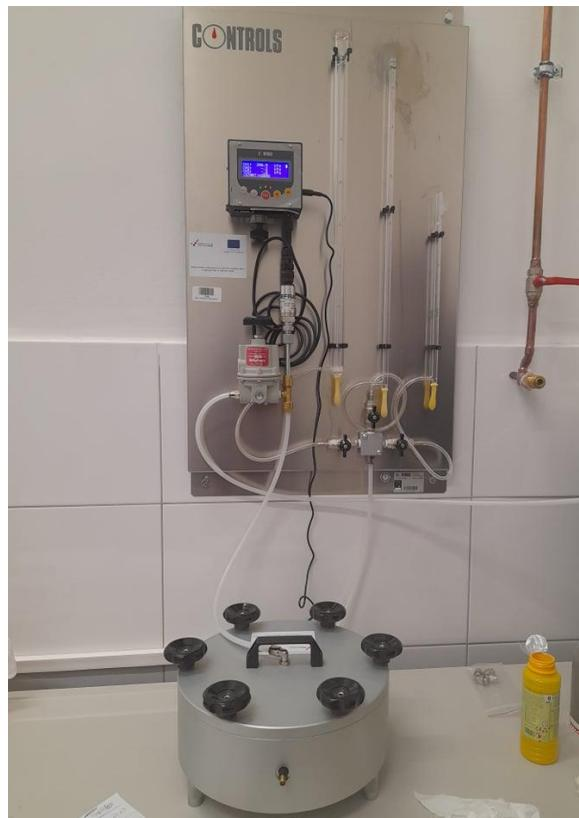
Slika 3.7. Uredaj za ispitivanje plinopropusnosti
