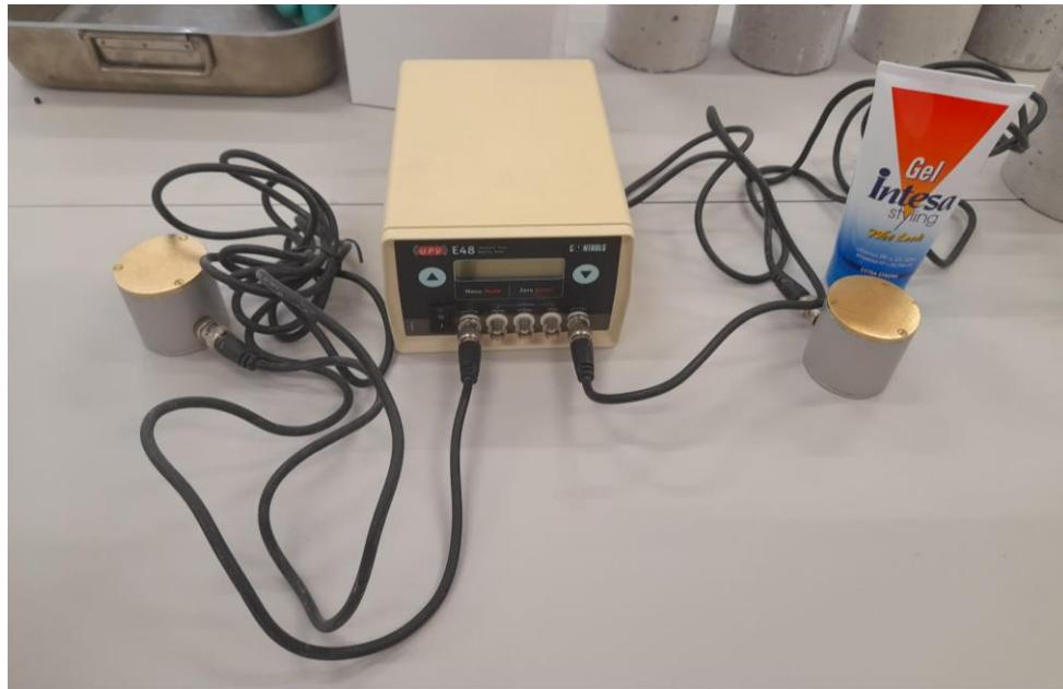
Slika 3.5. Uredaj za ispitivanje brzine ultrazvučnih valova
