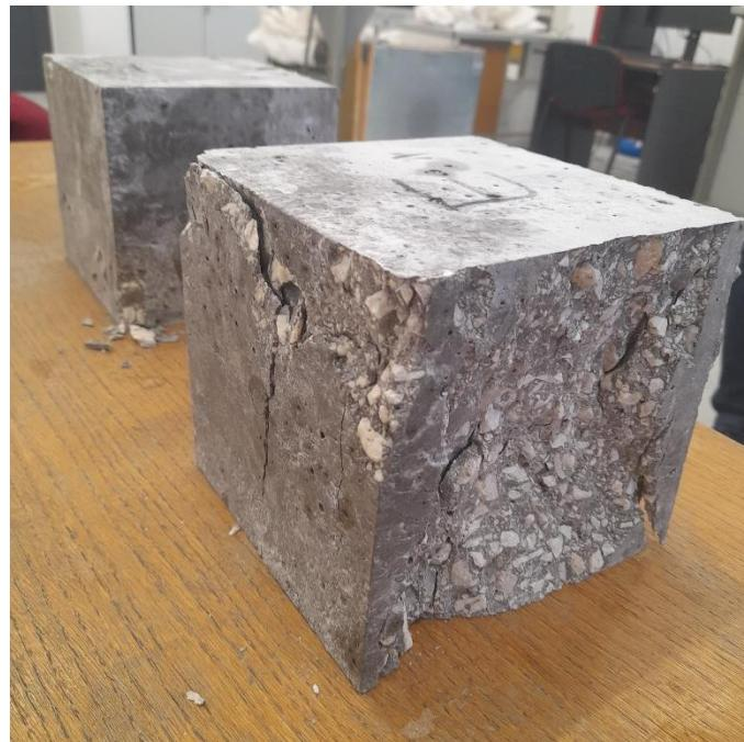
Slika 4.8. Ispitni uzorak E nakon ispitivanja tlačne čvrstoće
