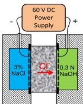
Slika 3.10. Prikaz ispitnog uzorka između naponskih ćelija [11]
