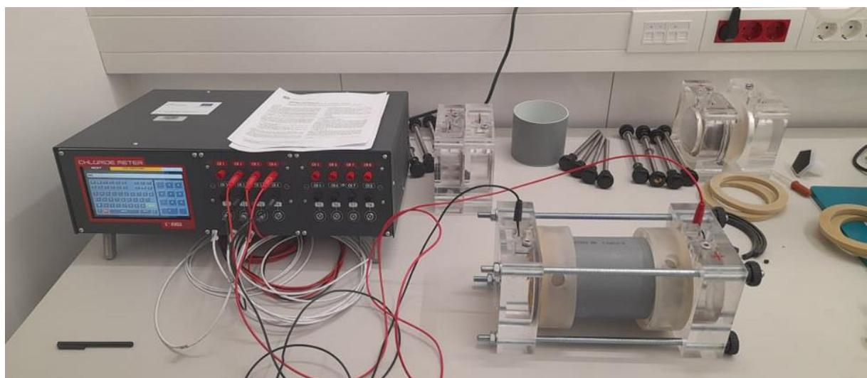
Slika 3.15. Uređaj za ispitivanje uzorka na kloride
