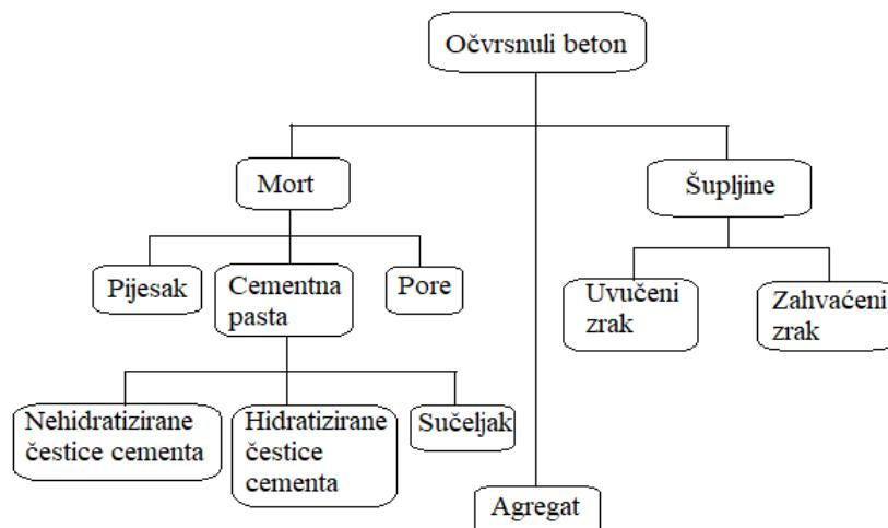
Slika 2.2. Struktura očvrsnulog betona [1]
