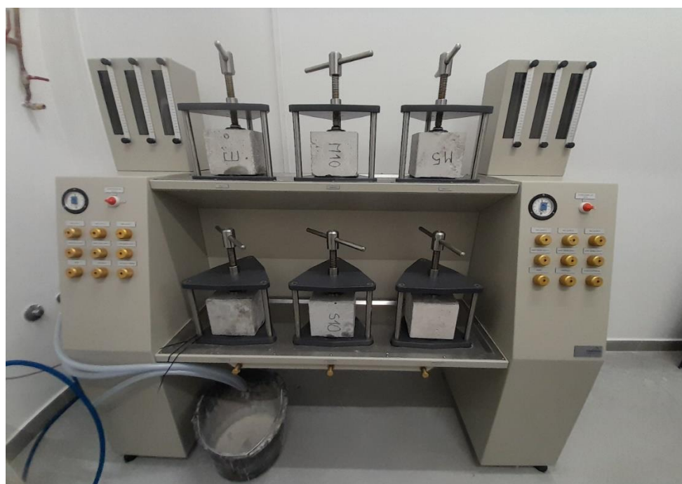
Slika 3.6. Uređaj za ispitivanje vodonepropusnosti
