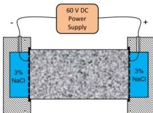
Slika 3.14. Prikaz ispitnog uzorka između naponskih čelija [11]
