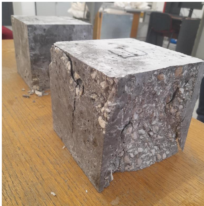
Slika 4.8. Ispitni uzorak E nakon ispitivanja tlačne čvrstoće
