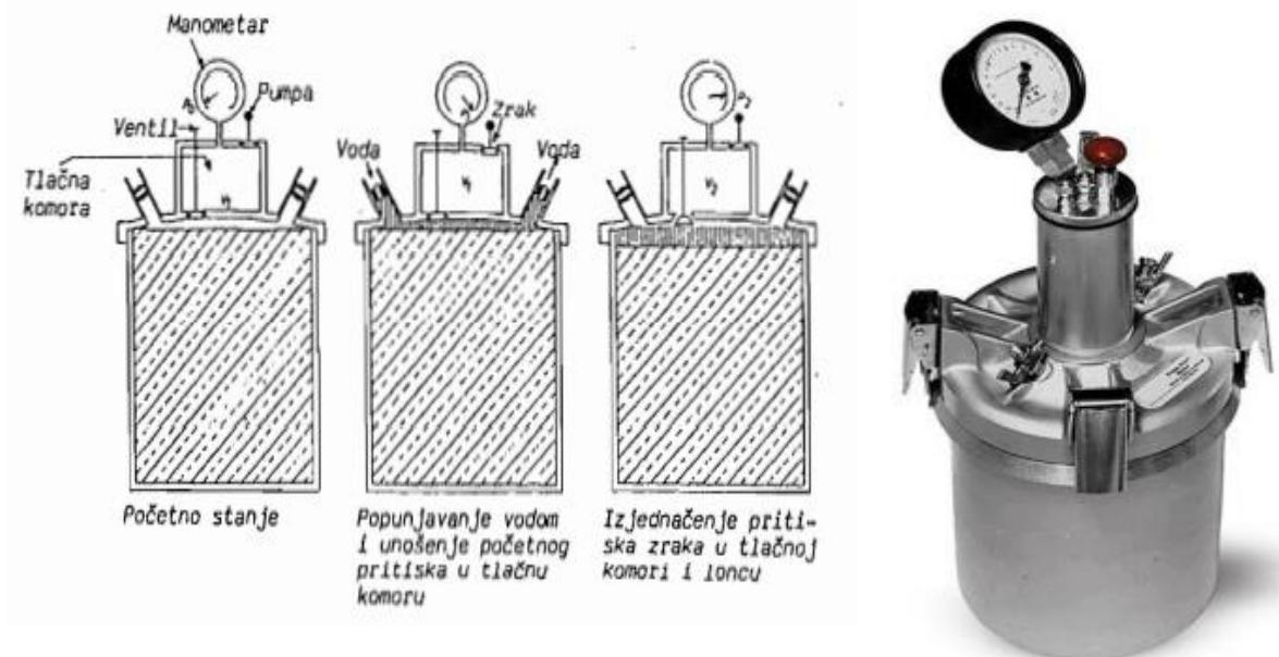
Slika 3.3. Porometar za ispitivanje pora u svježem betonu [2]
