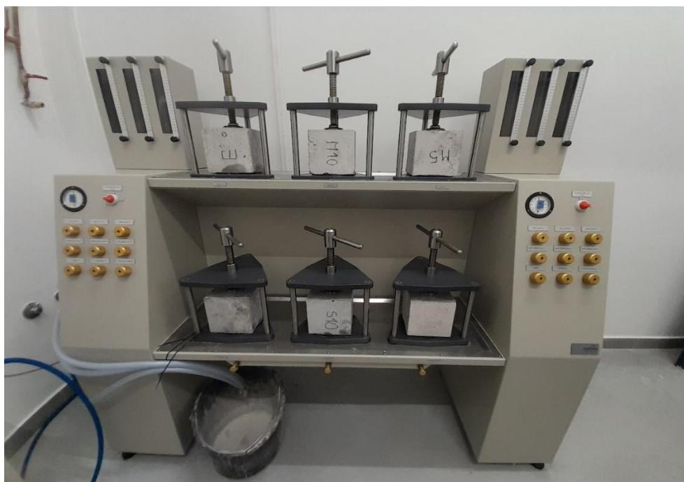
Slika 3.6. Uređaj za ispitivanje vodonepropusnosti
