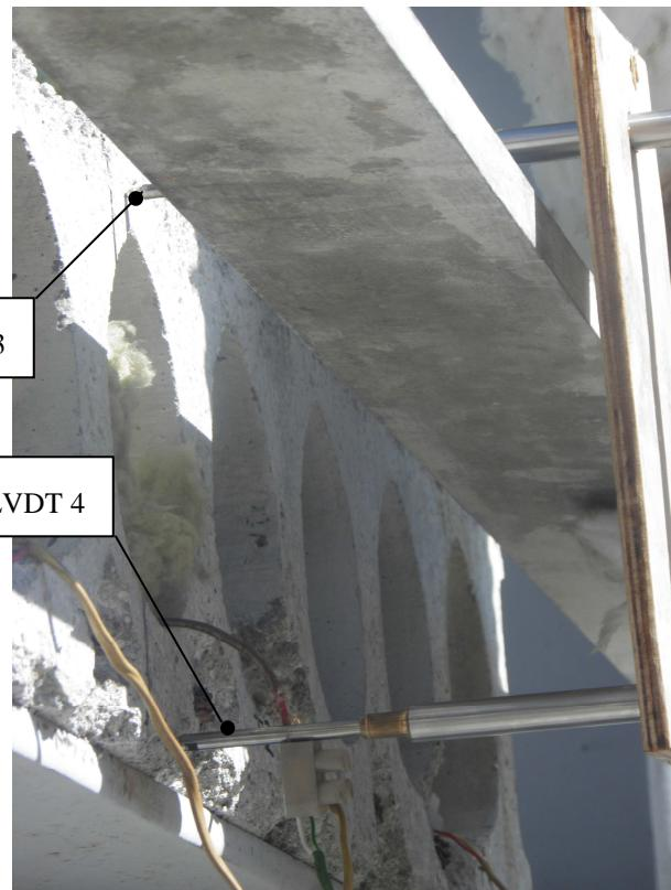
Fotografija 6.7. Prikaz LVDT uređaja za mjerjenje zaokreta ploče (LVDT 3 i LVDT 4)
