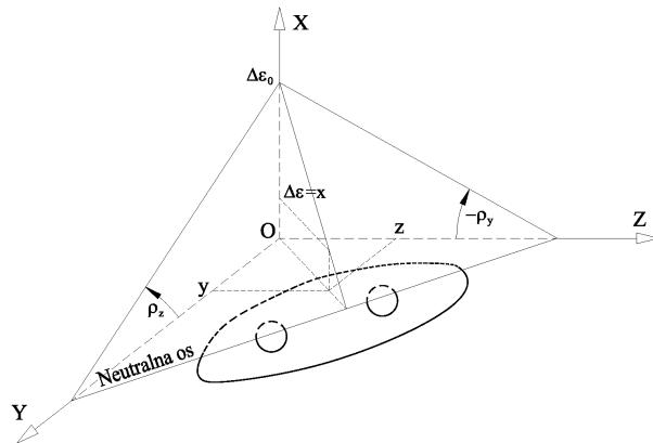
Crtež 4.3. Prikaz ravnine deformacije presjeka s komponentama po osima
