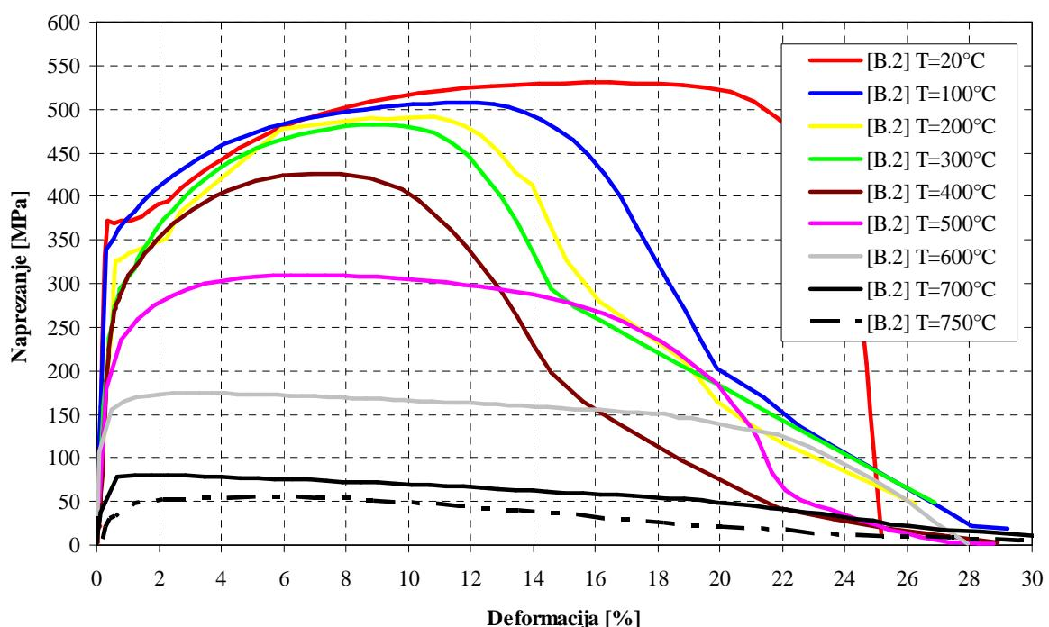
Grafikon 7.1. Krivulje naprezanje-deformacija [B.2] za čelik S355
