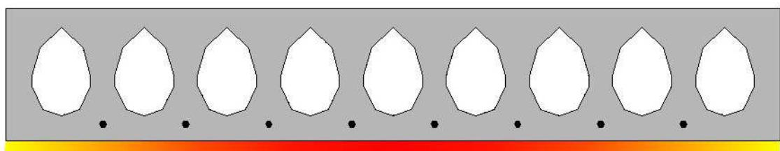
Crtež 7.15. Prikaz površina ploče pod utjecajem rubnog toplinskog toka
