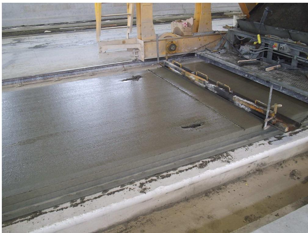
Fotografija 6.1. Prikaz procesa proizvodnje prednapetih šupljih ploča
