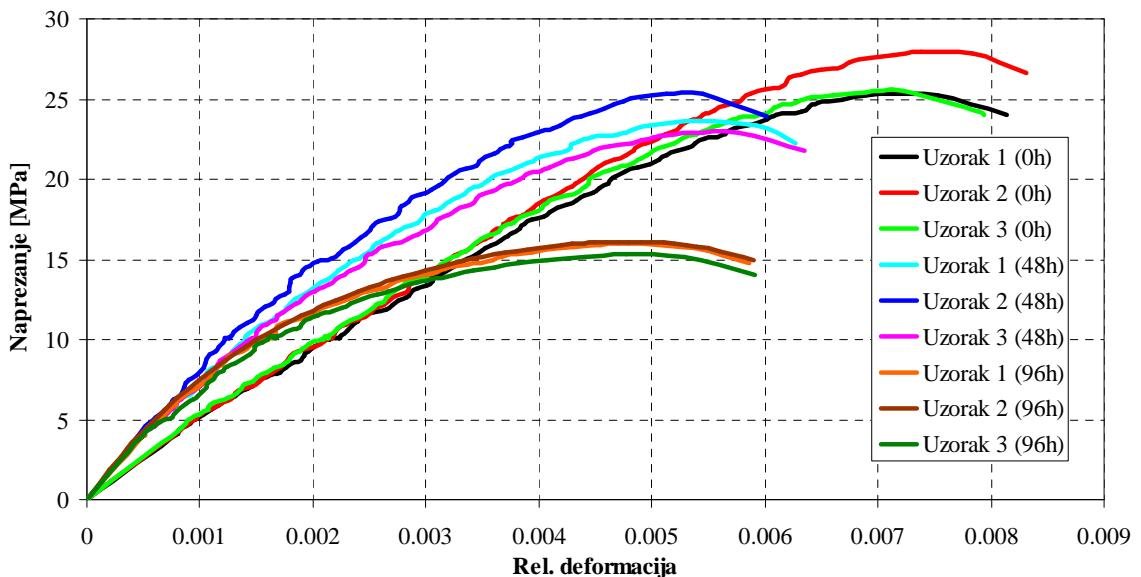
Grafikon 5.22. Usporedba krivulja naprezanje-deformacija - 600°C (0-96h)
