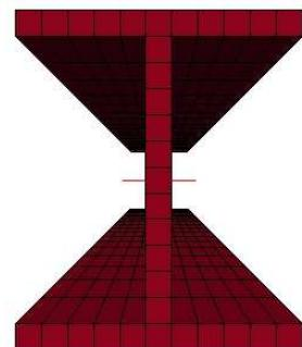
Crtež 7.5. Diskretizacija za proračun mehaničkih karakteristika presjeka za 1., 2., 4. i 5. primjer
