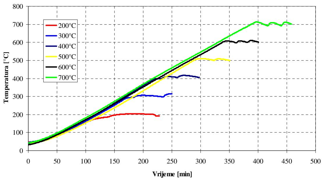
Grafikon 5.2. Prikaz srednjih temperatura uzorka – ciklus za određivanje tlačne čvrstoće vrućeg uzorka
