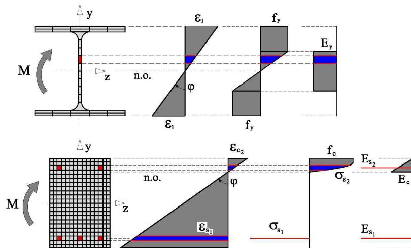
Crtež 4.6. Proračun unutrašnjih sila u poprečnom presjeku integracijom naprezanja po diskretnim područjima poprečnog presjeka
