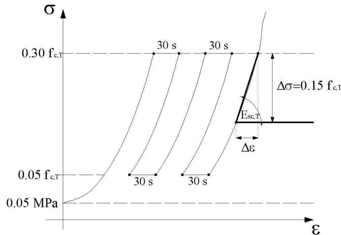
*Crtanje 5.2.* Shema opterećivanja uzorka za određivanje sekantnog modula elastičnosti
