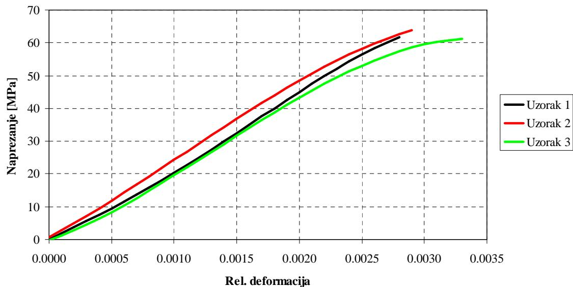
Grafikon 5.4. Krivulje naprezanje-deformacija vrućih uzoraka – 20°C
