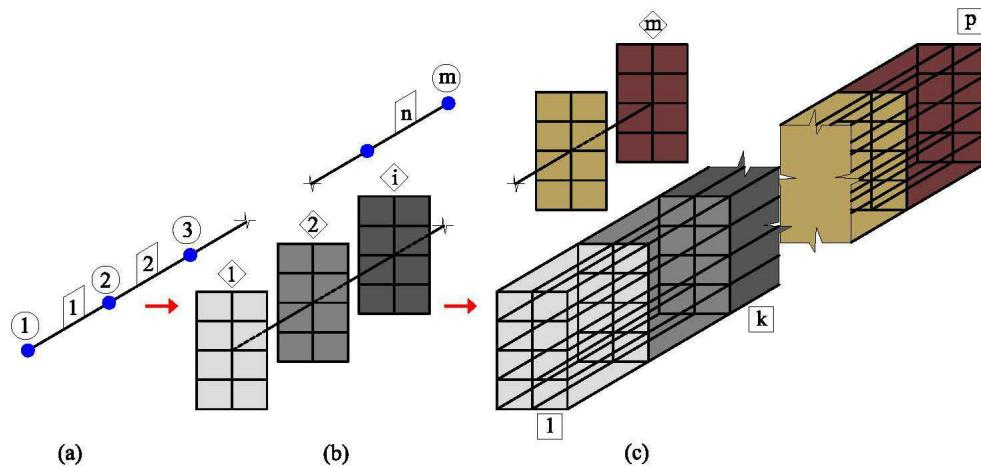
Crtež 4.8. Veza između pojedinih numeričkih podmodela - (a) diskretizacija štapne konstrukcije; (b) diskretizacija modela za nelinearni proračun mehaničkih karakteristika; (c) diskretizacija za model provođenja topline
