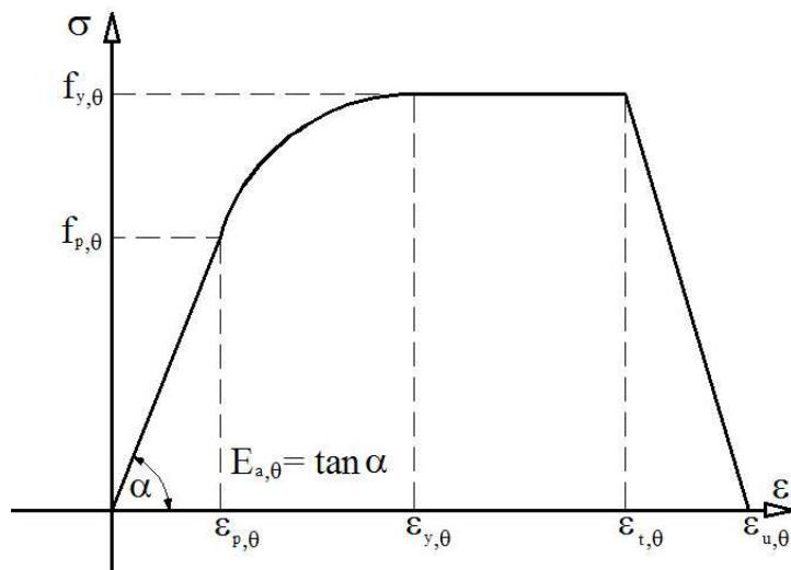
Crtež 4.15. Krivulje naprezanje-deformacija za čelik prema [E.2]
