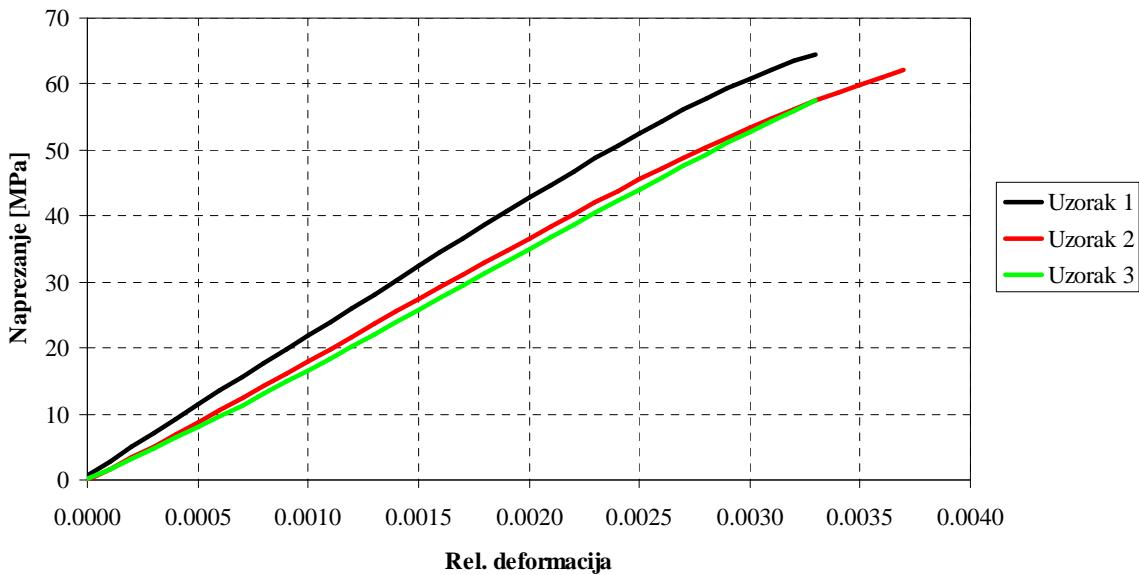
Grafikon 5.5. Krivulje naprezanje-deformacija vrućih uzoraka – 200°C
