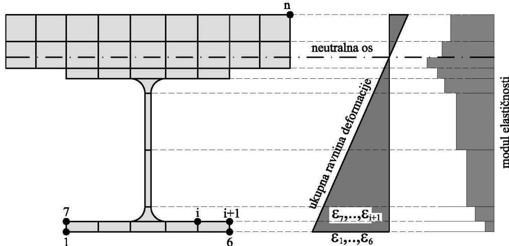
Crtež 4.7. Diskretizacija kompozitnog poprečnog presjeka
