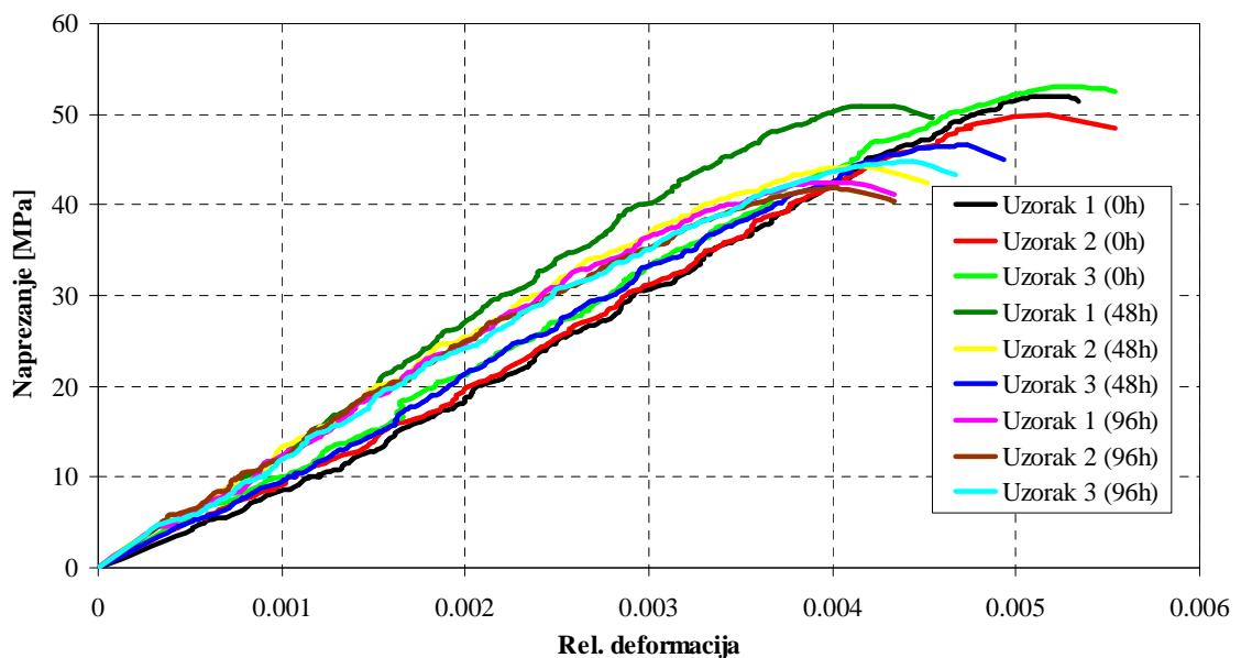
Grafikon 5.20. Usporedbe krivulja naprezanje-deformacija - 400°C (0-96h)
