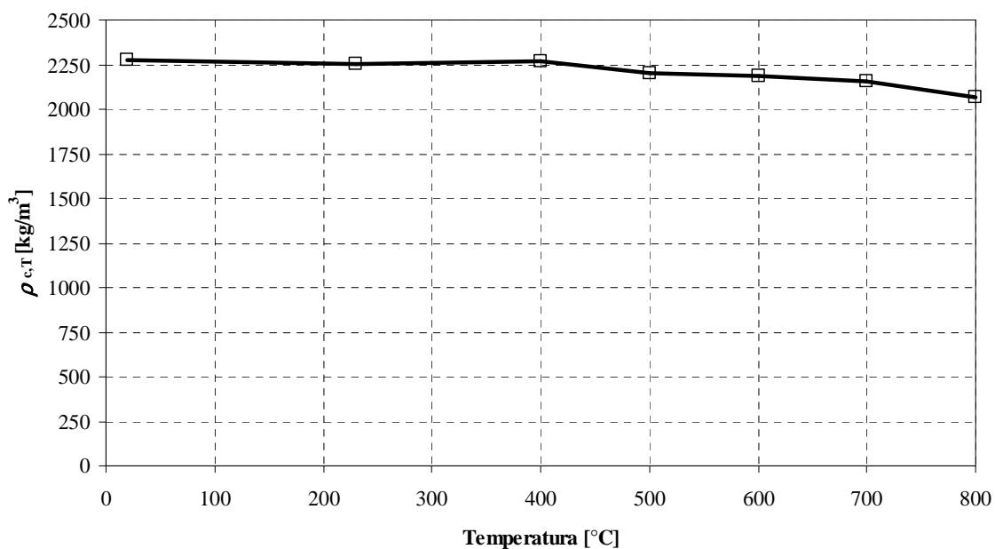
Grafikon 5.26. Prikaz smanjenja zapreminske težine betonskih uzoraka u ovisnosti o temperaturi
