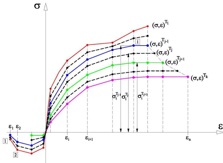
Crtež 4.5. Interpolacija nelinearne veze naprezanje-deformacija  $(\sigma, \epsilon)^{T_j}$  za temperaturu  $T_j$
