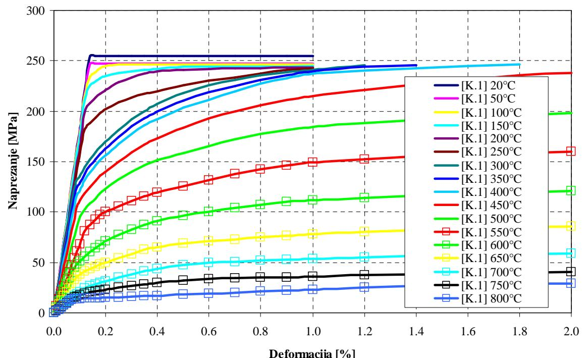
Grafikon 7.3. Krivulje naprezanje-deformacija [K.1] za čelik S275
