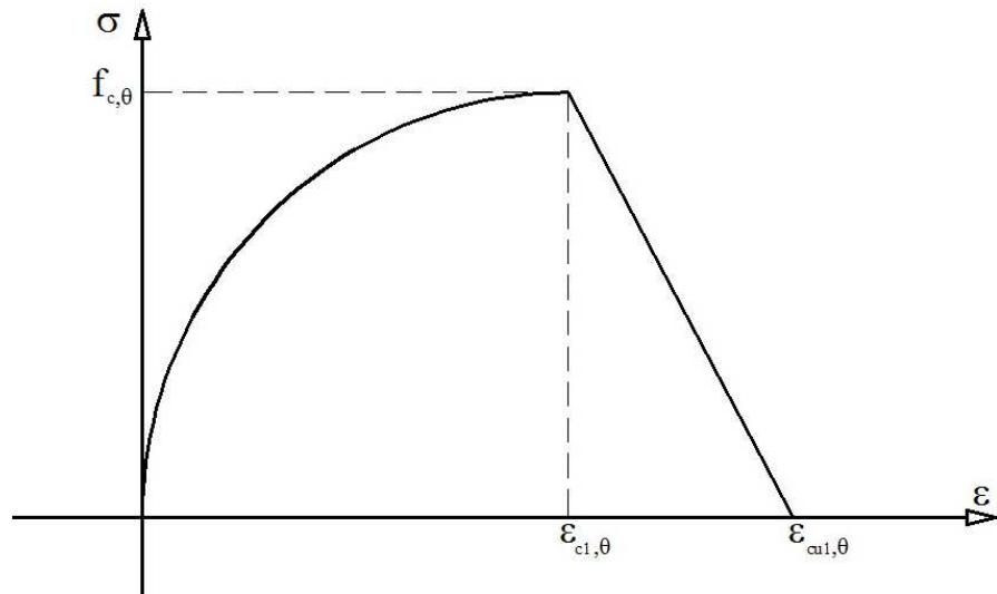
Crtež 4.16. Krivulje naprezanje-deformacija za beton prema [E.3]
