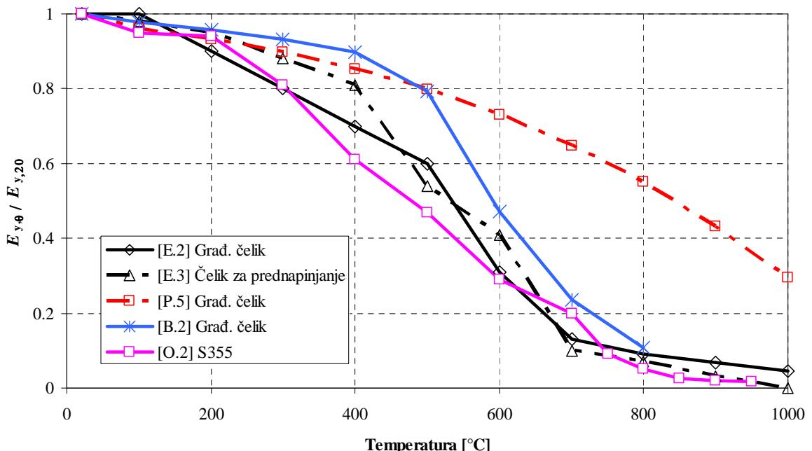
Grafikon 2.3. Smanjenje modula elastičnosti čelika  $E_{y,\theta}$  u normaliziranom obliku pri visokim temperaturama
