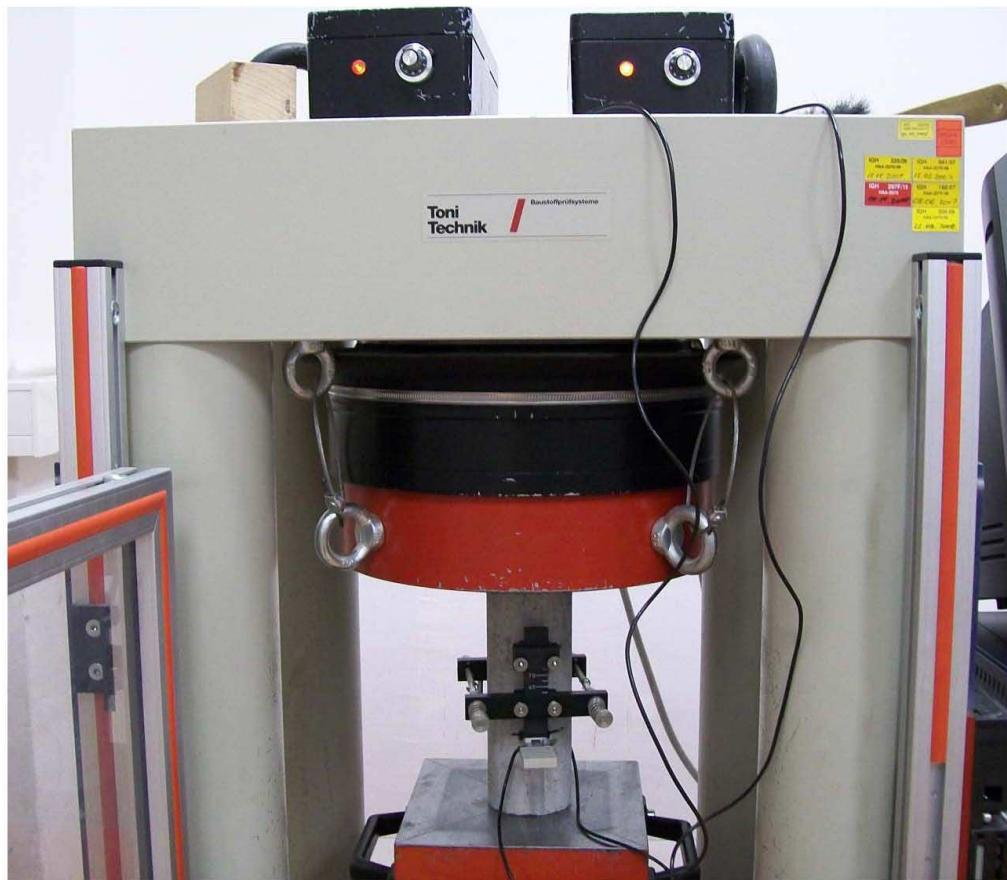
Fotografija 5.9. Uzorak s postavljenim ekstenzometrima za mjerjenje relativnog pomaka
