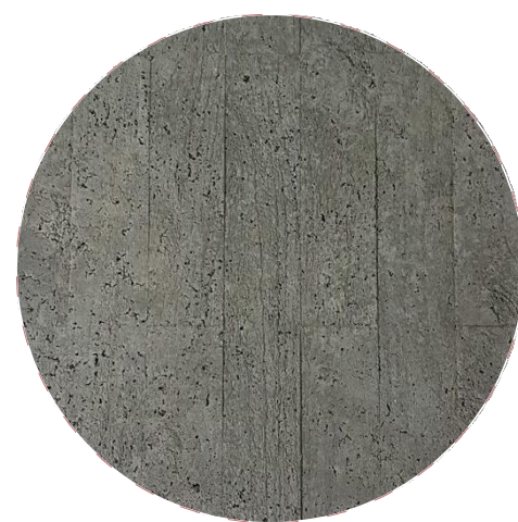
Zidovi od sunčališta, vertikalni dijelovi krova od bazenske dvorane i svi vertikalni elementi koji nisu konstrukcija ili zidovi jednog od tri volumena rade se kao natur beton u završnoj obradi.
