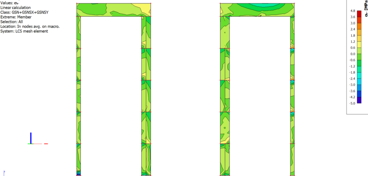
Slika 9.1.11. Naprezanja \sigma_x za anvelopu opterećenja (GSNSX+GSNSY+GSN)
