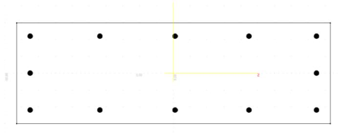
Slika 9.5. Poprečni presjek s armaturom (Aspalathos Section Design)
