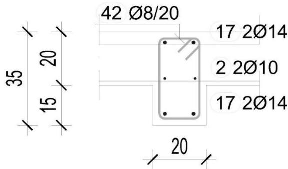
Slika 8.29. Poprečni presjek grede 303
