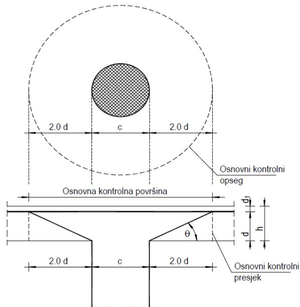
Slika 9.8. Proboj ploče
