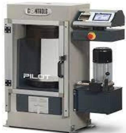
Slika 4.1. Uredaj za ispitivanje karakteristične tlačne čvrstoće
