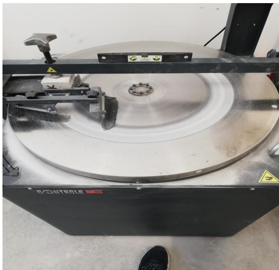
Slika 7.9. Uredaj za ispitivanje habanja-Bohmeov disk
