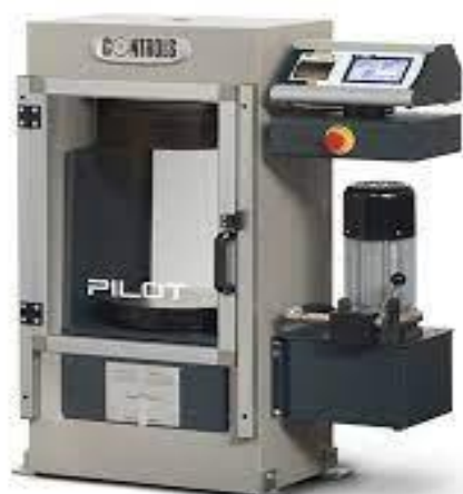
Slika 4.1. Uređaj za ispitivanje karakteristične tlačne čvrstoće
