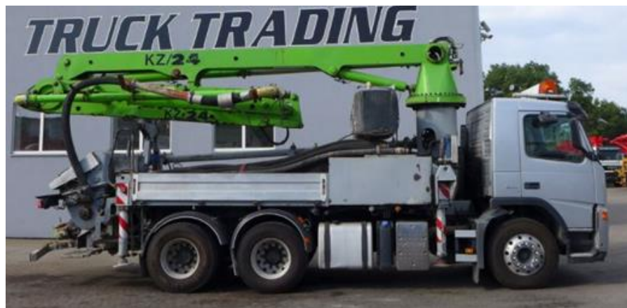
Slika 5.6 Pumpa za beton Volvo FM 340 [9]
