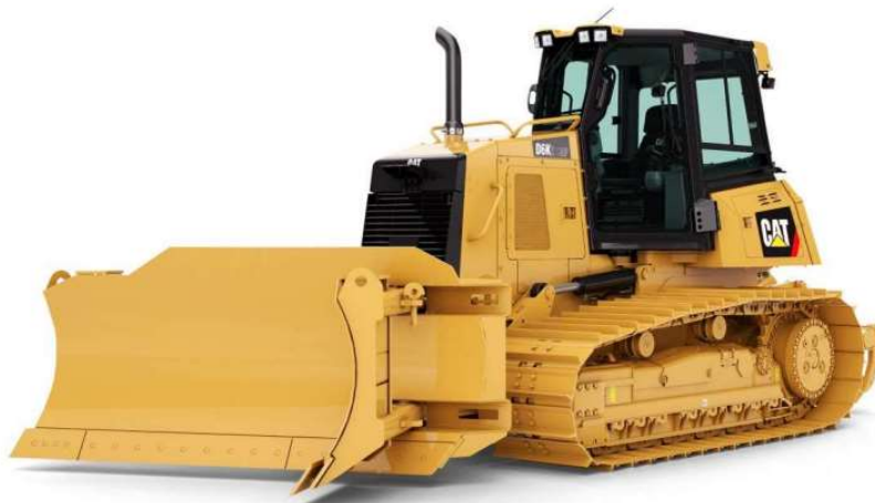
Slika 4.1 Dozer CAT D6K [4]
