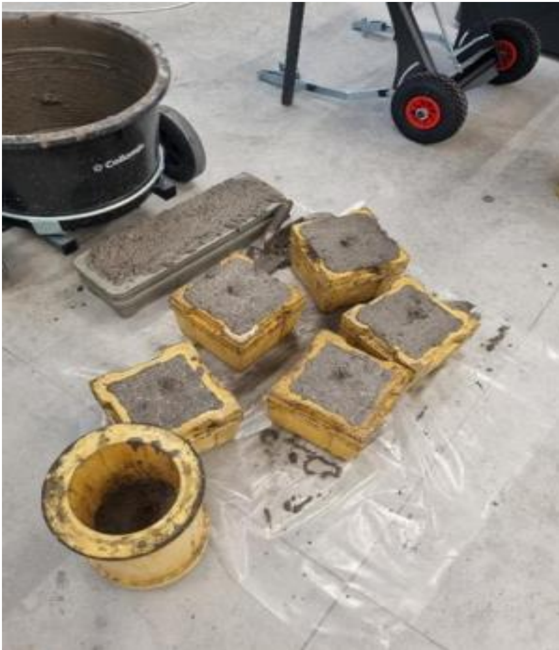
Slika 4.3 Izrada betona pomoću kalupa [5]
