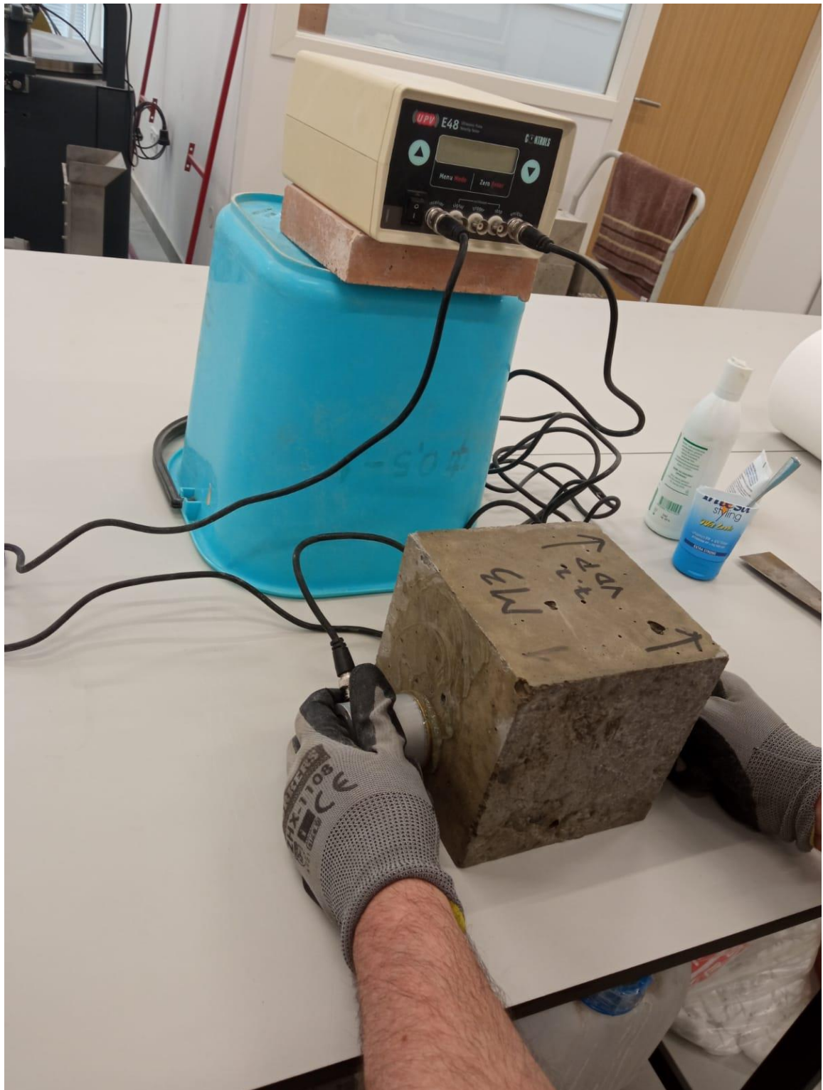
Slika 4.4.7 Ispitivanje brzine širenja ultrazvučnih valova u betonu
