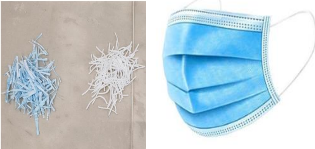
Slika 4.2.7 Jednokratna maska za lice i primjer izrezanih maski koje su korištene za mješavine
