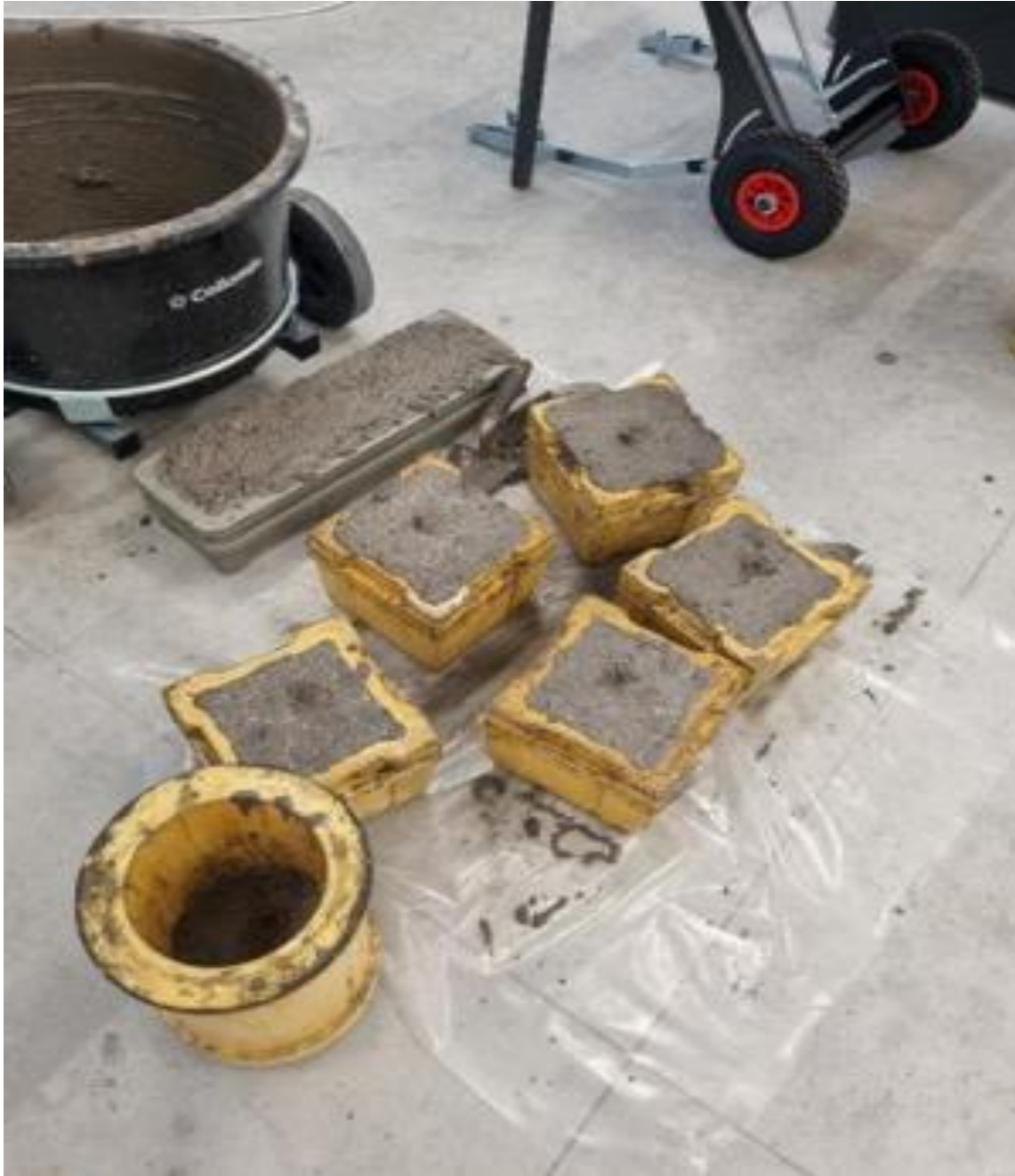
Slika 4.3 Izrada betona pomoću kalupa [5]
