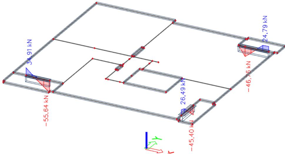
Slika 7.10. Prikaz poprečnih sila za grede pozicije 300
