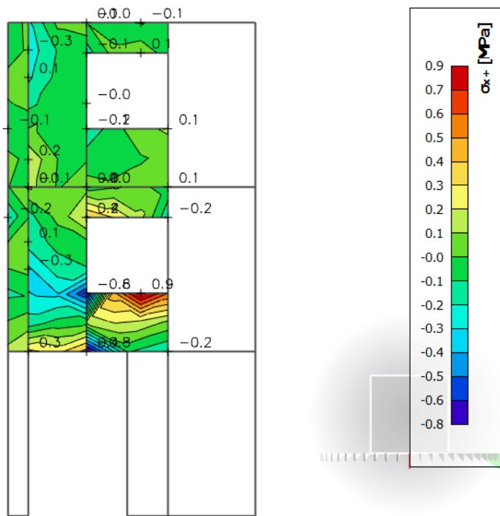
*Slika 8.2. Naprezanja u smjeru x*
