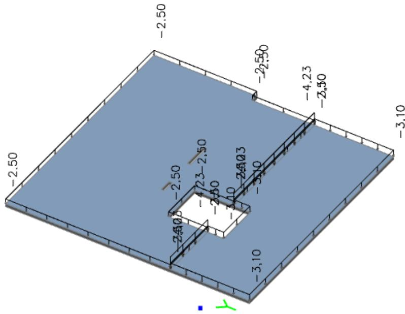
Slika 6.10. Dodatno stalno opterećenje ( $kN/m^2$ )
