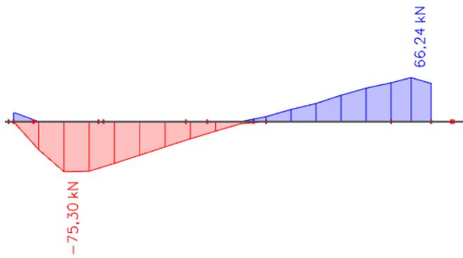
Slika 7.4. Prikaz poprečnih sila grede -  $V_z$
