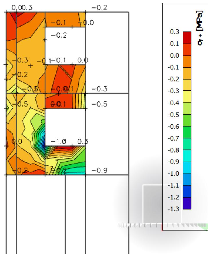
*Slika 8.3. Naprezanja u smjeru y*
