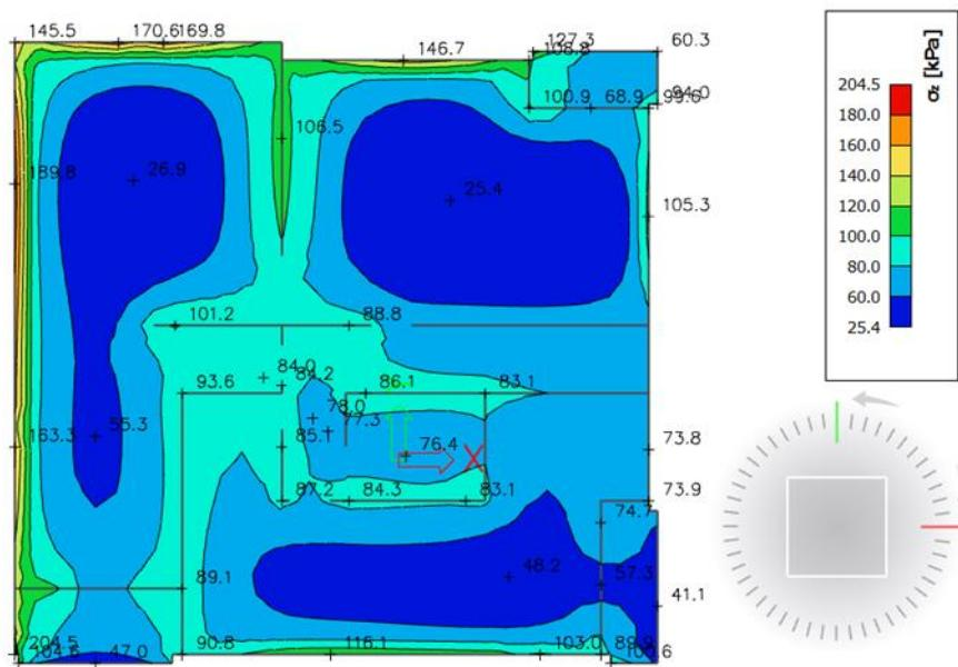
**Slika 10.1.** Naprezanja u tlu za kvazistalnu kombinaciju  $1,0G+1,0Q$
