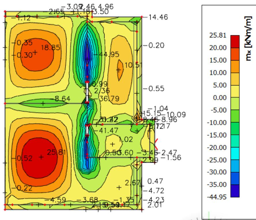
Slika 6.5. Prikaz momenata savijanja na ležajevima  $M_x$  – GSN1
