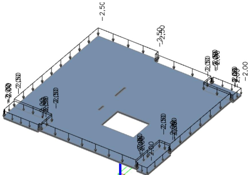
Slika 6.19. Dodatno stalno opterećenje ( $kN/m^2$ )
