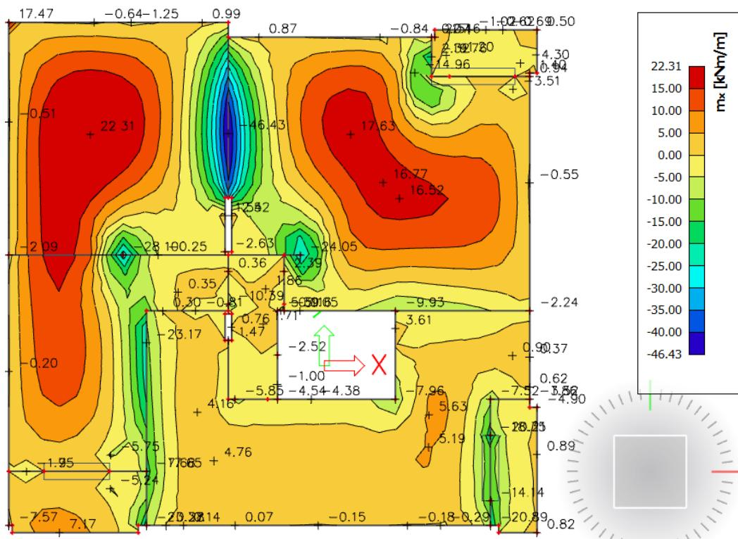
*Slika 6.23. Prikaz momenata savijanja na ležajevima Mx – GSN1*
