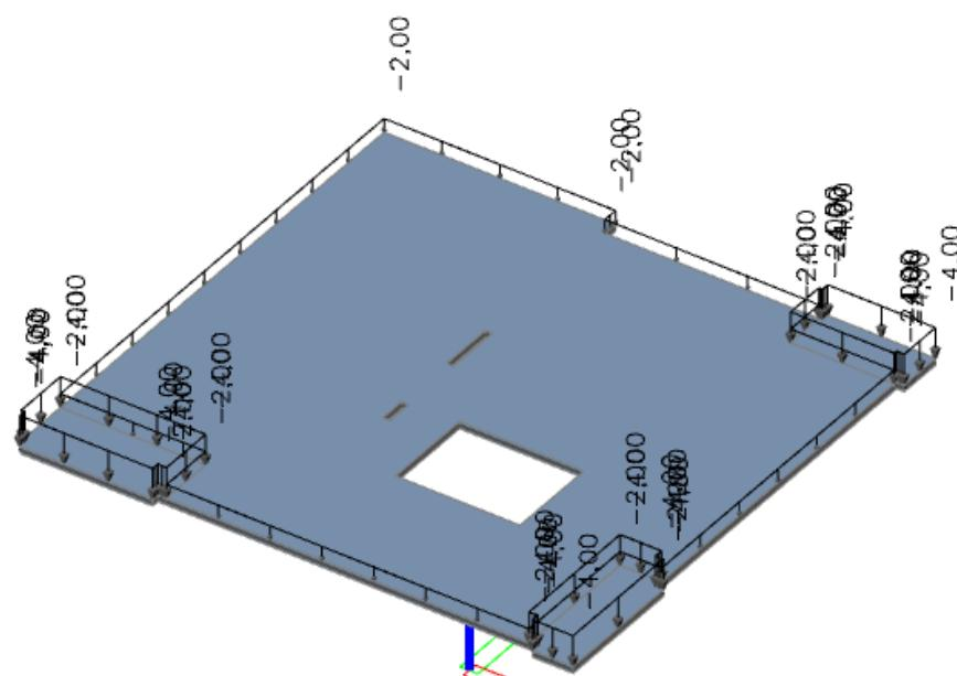
Slika 6.20. Dodatno stalno opterećenje ( $kN/m^2$ )
