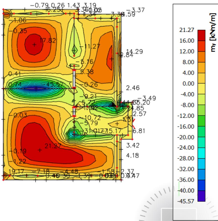
Slika 6.6. Prikaz momenata savijanja na ležajevima  $M_y$  – GSN1
