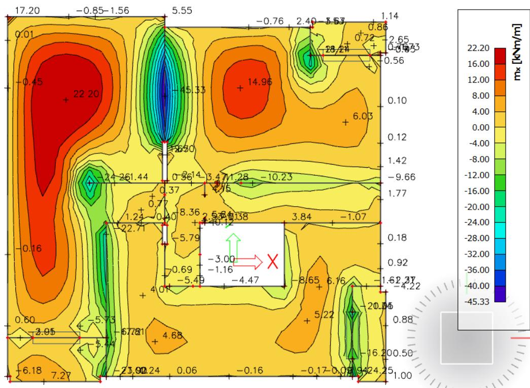
Slika 6.32. Prikaz momenata savijanja na ležajevima  $M_x$  – GSN1
