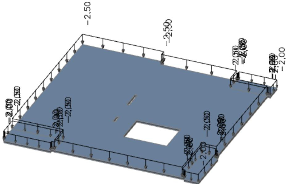
*Slika 6.28. Dodatno stalno opterećenje ( $kN/m^2$ )*
