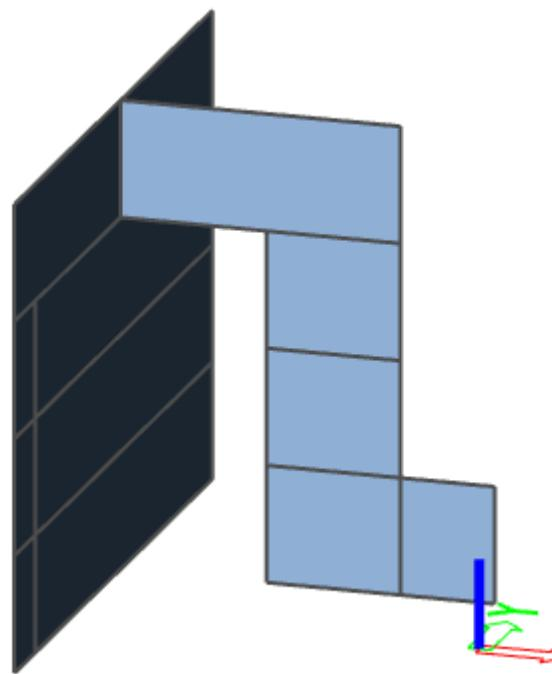
*Slika 8.8. Prikaz visokostijenog nosača u modelu*
