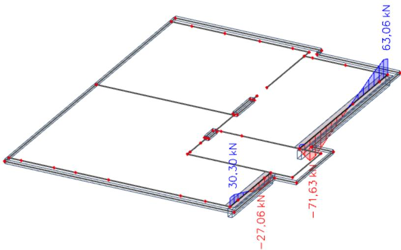
Slika 7.2. Prikaz poprečnih sila za grede pozicije 400
