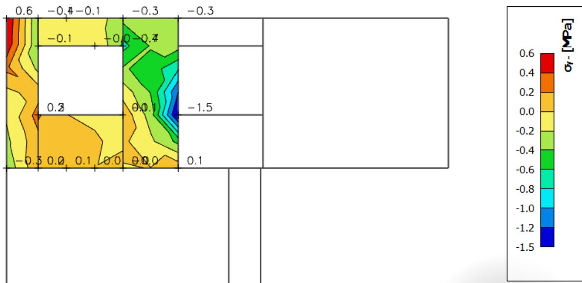
*Slika 8.19. Naprezanja u smjeru y*
