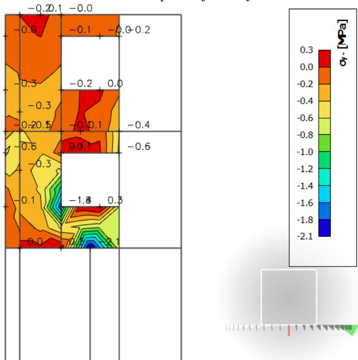
*Slika 8.5. Naprezanja u smjeru y*
