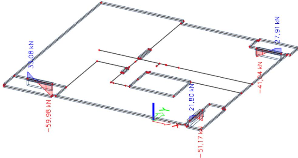
Slika 7.12. Prikaz poprečnih sila za grede pozicije 300
