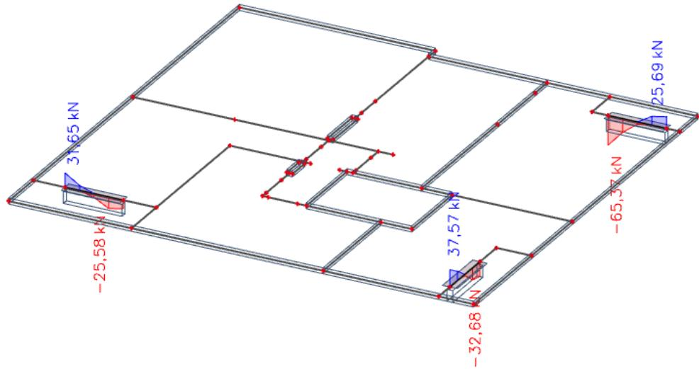
Slika 7.8. Prikaz poprečnih sila za grede pozicije 300
