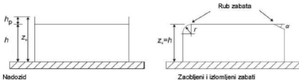
Slika 4.8 Način izvedbe ravnog krova
