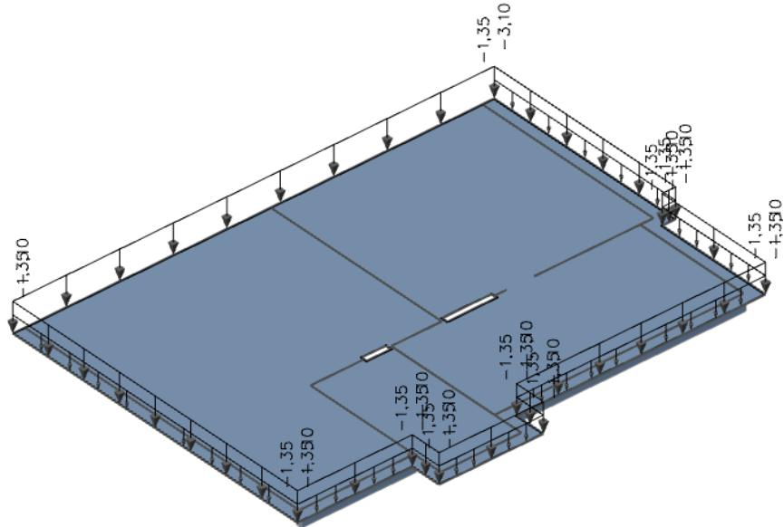
Slika 6.1. Dodatno stalno opterećenje ( $kN/m^2$ )
