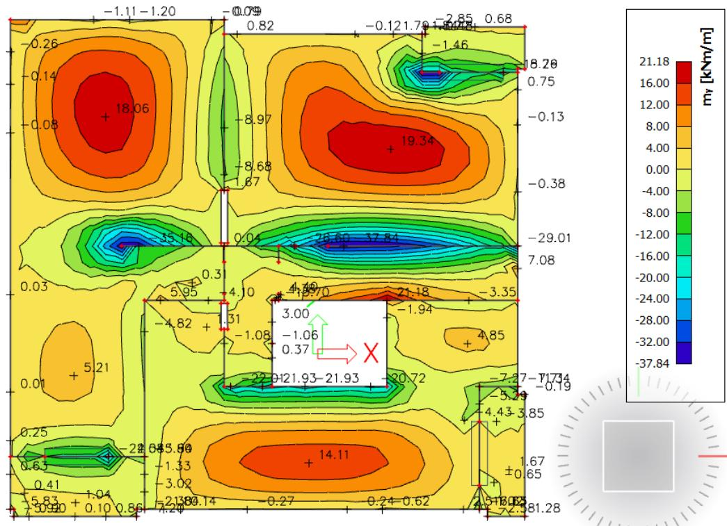
Slika 6.33. Prikaz momenata savijanja na ležajevima  $M_y$  – GSN1
