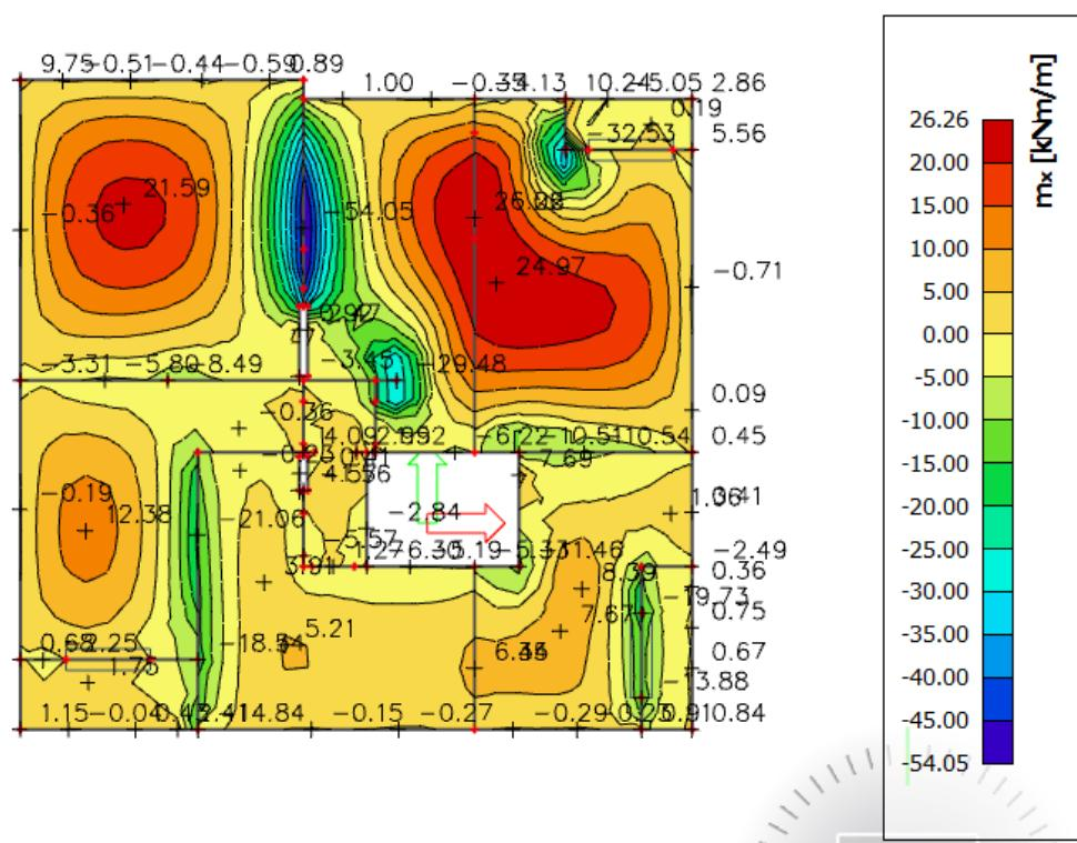
Slika 6.12. Prikaz momenata savijanja u polju  $M_x$  – GSN2
