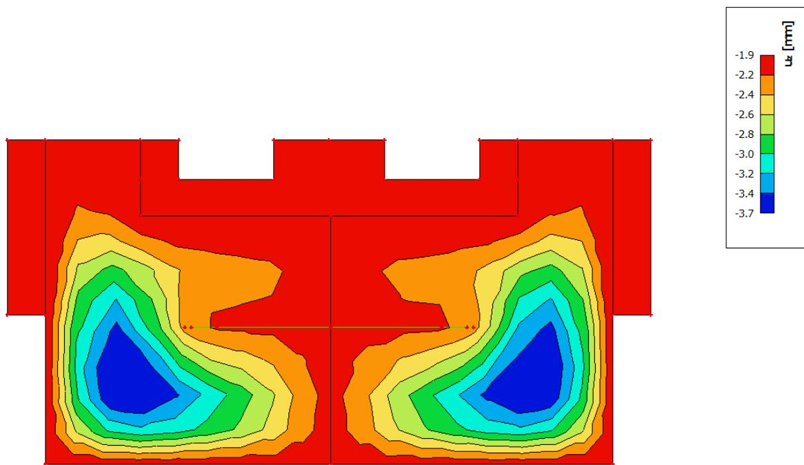
Slika 6.10 Progib ploče (mm) za kombinaciju GSU-2
