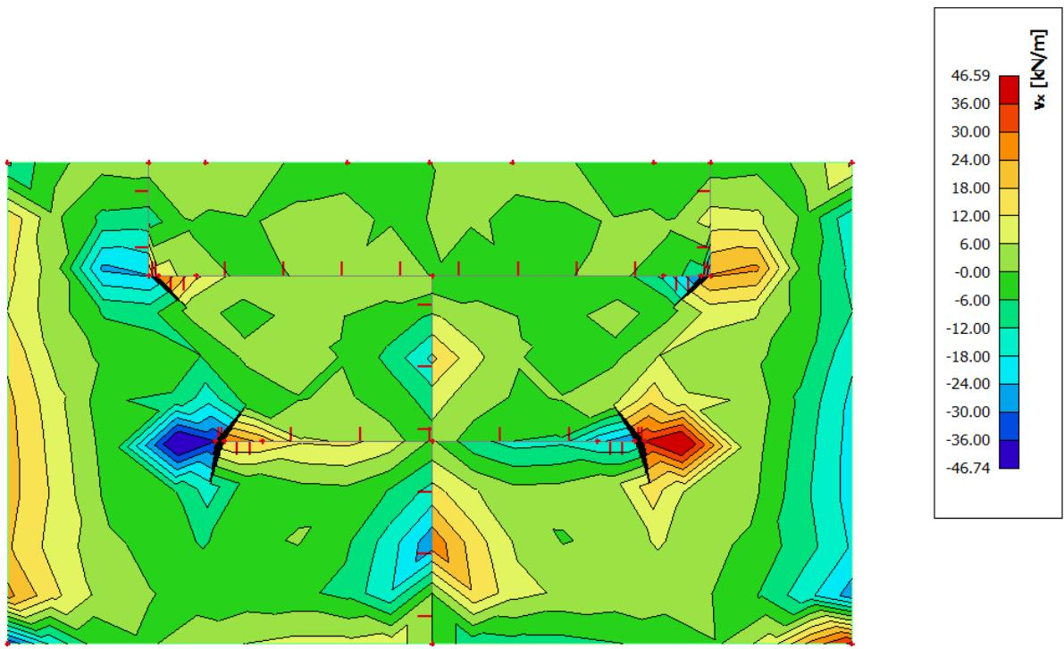
Slika 6.17 Poprečne sile  $V_{Ed,x}$  (kN/m) za GSN-1
