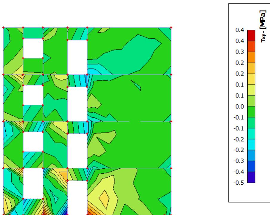
Slika 8.2.10 Posmična naprezanja u zidu  $\tau_{xy-}$  za kombinaciju GSN-I
