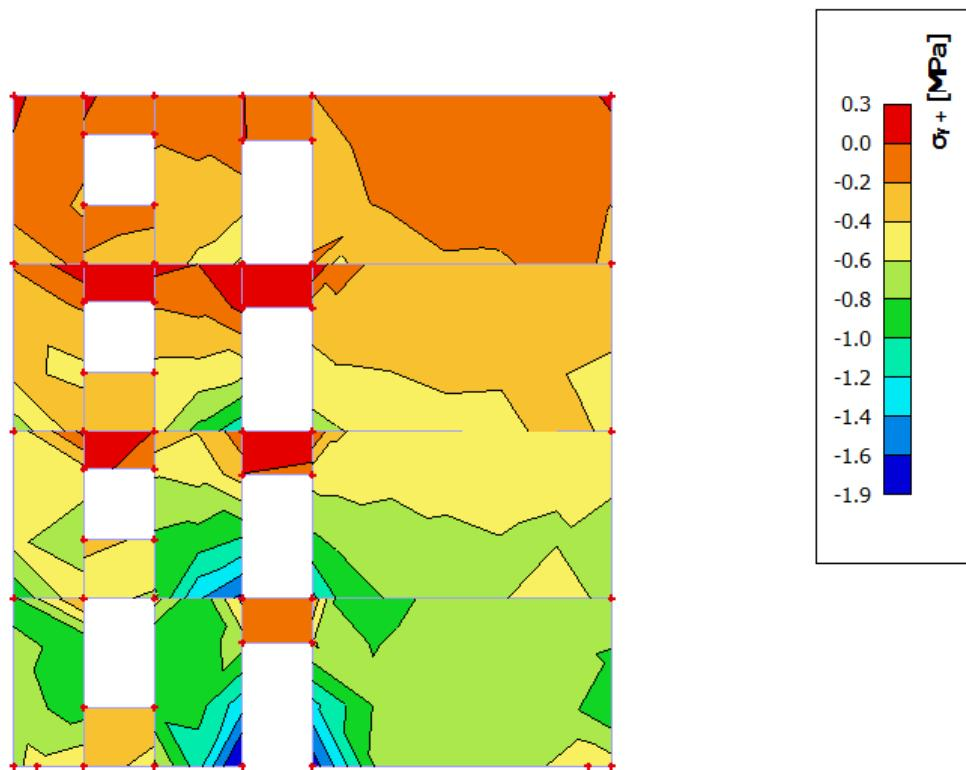
Slika 8.2.7 Naprezanja u zidu  $\sigma_y+$  za kombinaciju GSN-1
