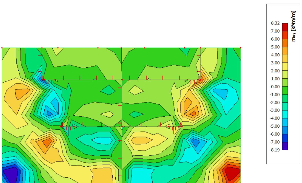
Slika 6.16 Moment savijanja  $M_{Ed,xy}$  (kNm/m) za GSN-1
