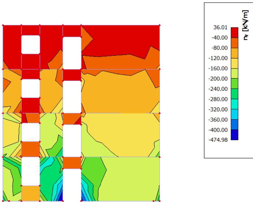
Slika 8.2.4 Uzdužne sile  $n_{Ed}$  [kN/m] u smjeru Y, u zidovima za anvelopu GSN
