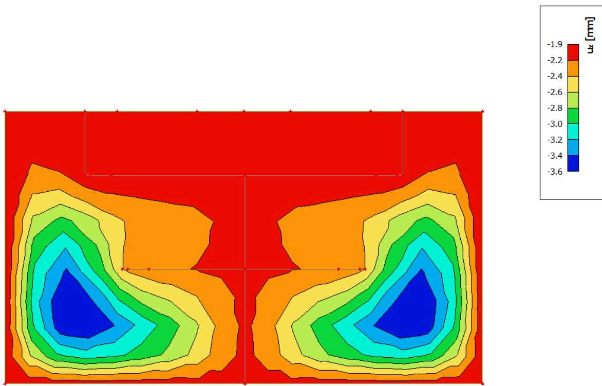
Slika 6.22 Progib ploče (mm) za kombinaciju GSU-2
