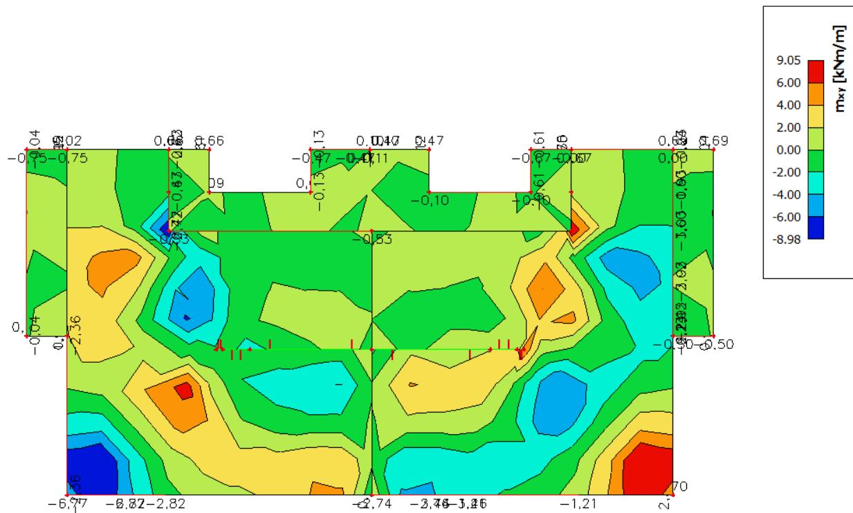
Slika 6.4 Moment savijanja  $M_{Ed,xy}$  (kNm/m) za GSN-1
