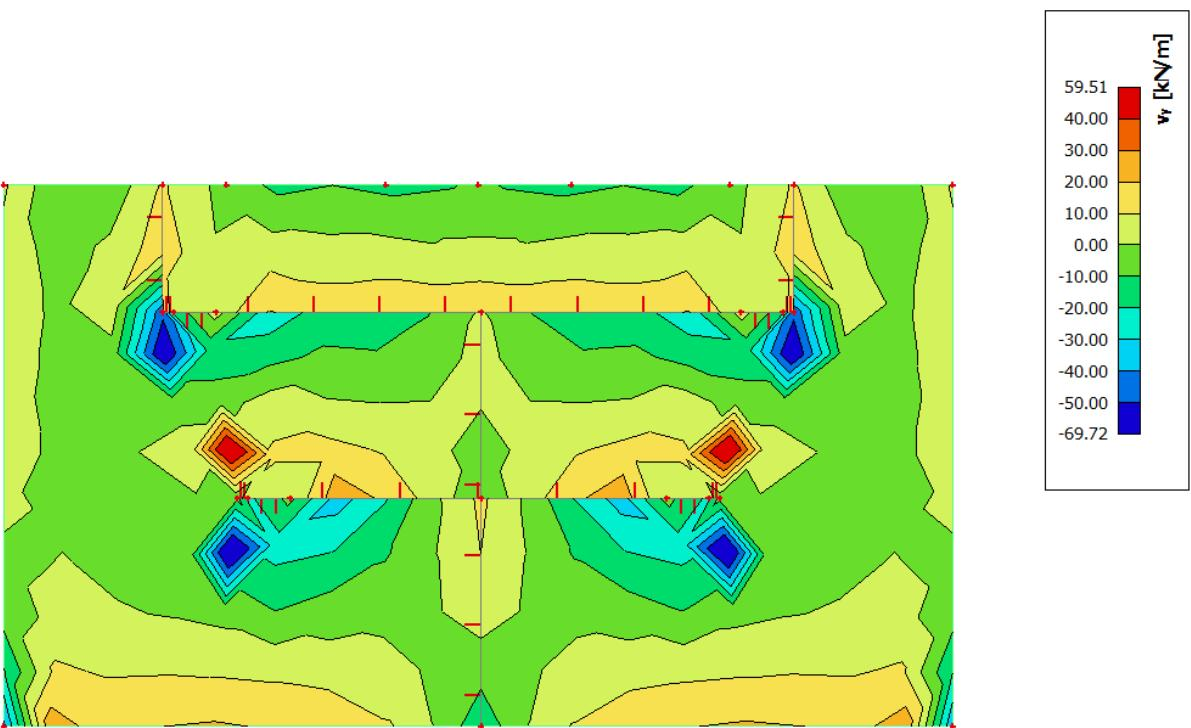
Slika 6.18 Poprečne sile  $V_{Ed,y}$  (kN/m) za GSN
