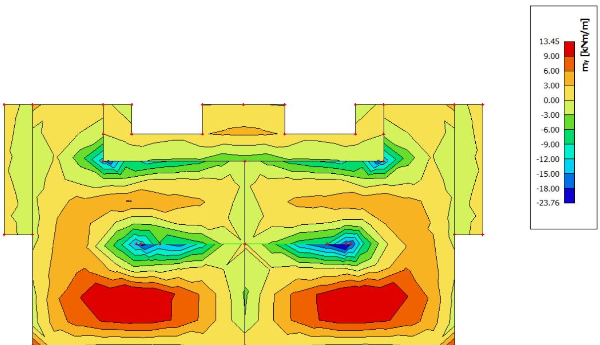
Slika 6.12 Moment savijanja  $M_{Ed,y}$  (kNm/m) za GSU-1
