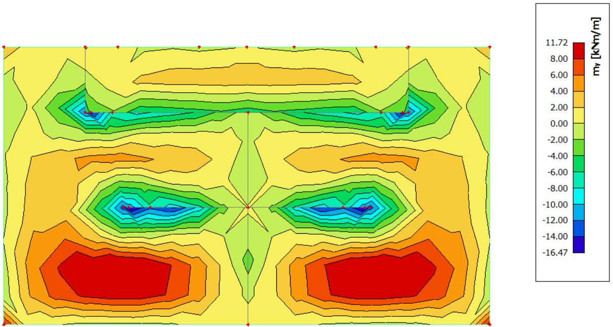
Slika 6.24 Moment savijanja  $M_{Ed,y}$  (kNm/m) za GSU-1
