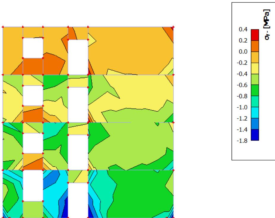
Slika 8.2.8 Naprezanja u zidu  $\sigma_y-$  za kombinaciju GSN-1
