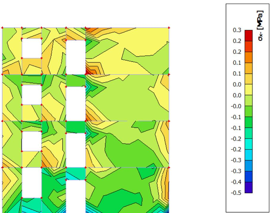
Slika 8.2.6 Naprezanja u zidu  $\sigma_{x-}$  za kombinaciju GSN-1
