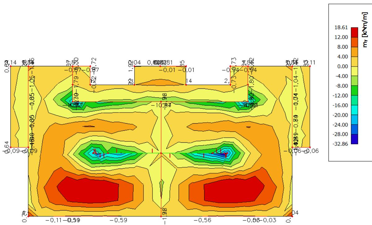
Slika 6.3 Moment savijanja  $M_{Ed,y}$  (kNm/m) za GSN-1
