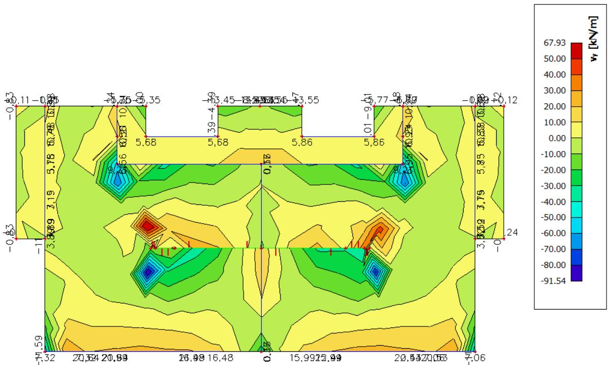
Slika 6.6 Poprečne sile  $V_{Ed,y}$  (kN/m) za GSN-1
