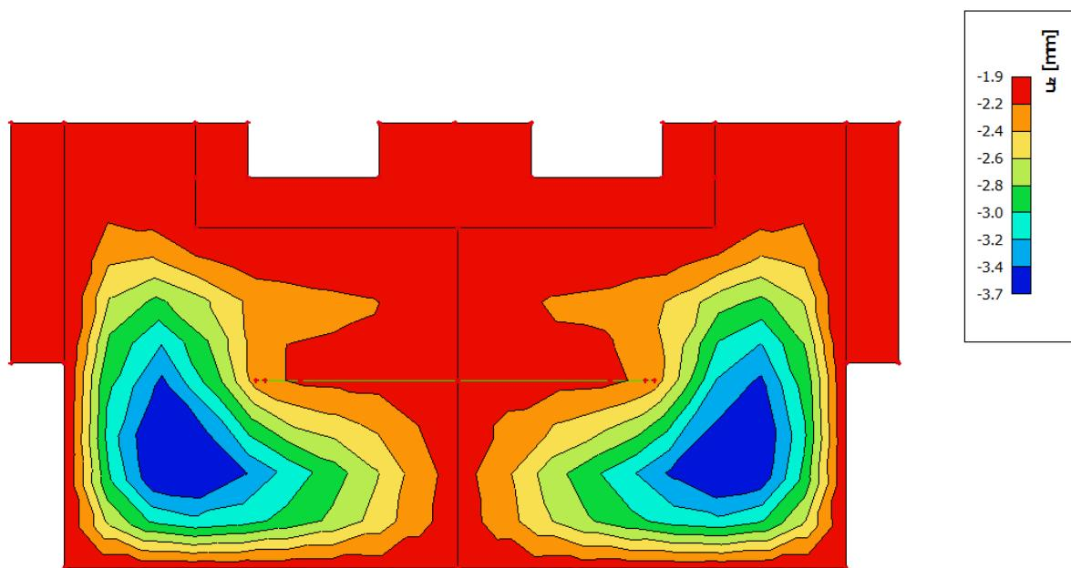
*Slika 6.9 Progib ploče (mm) za kombinaciju GSU-1*
