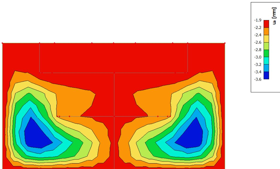
Slika 6.21 Progib ploče (mm) za kombinaciju GSU-1
