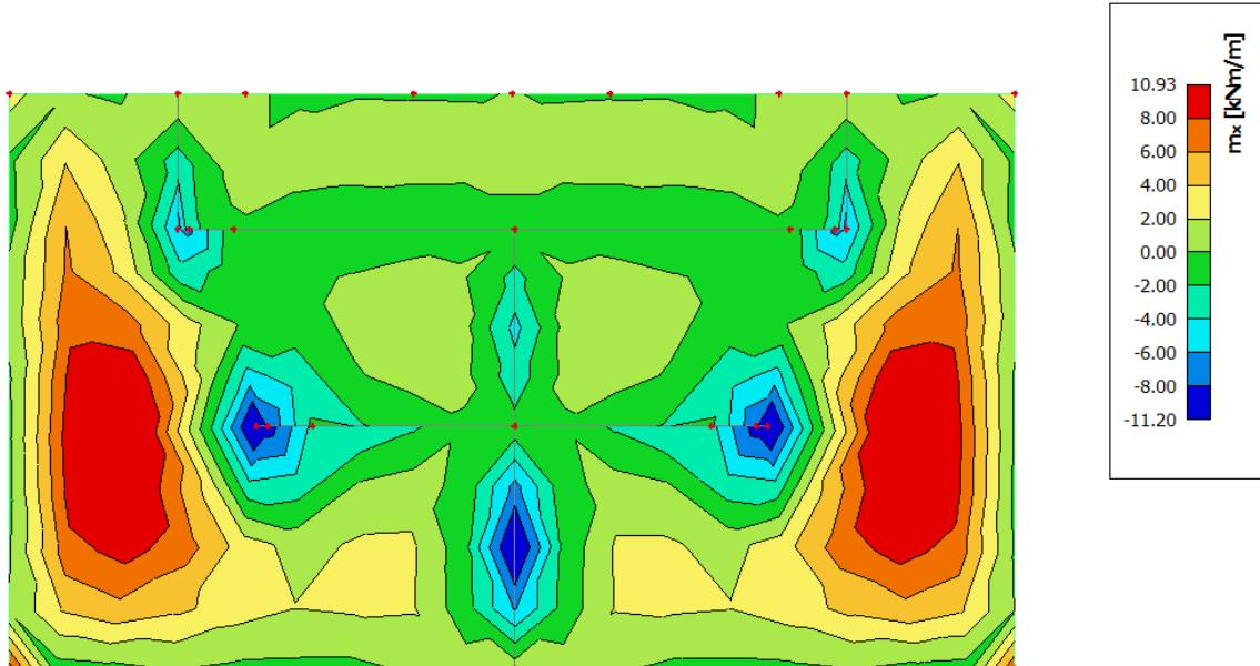
Slika 6.23 Moment savijanja  $M_{Ed,x}$  (kNm/m) za GSU-1
