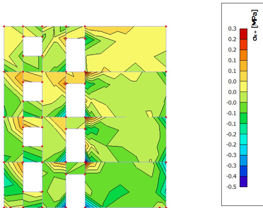
Slika 8.2.5 Naprezanja u zidu  $\sigma_{x+}$  za kombinaciju GSN-1
