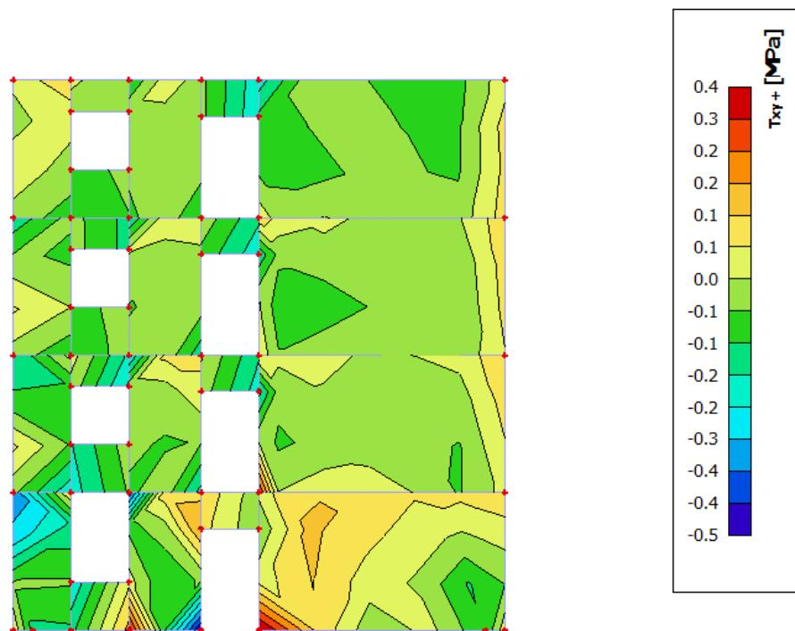
Slika 8.2.9 Posmična naprezanja u zidu  $\tau_{xy+}$  za kombinaciju GSN-I
