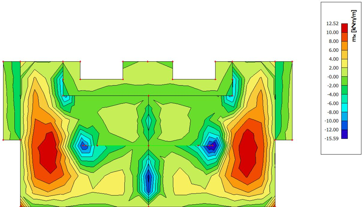
Slika 6.11 Moment savijanja  $M_{Ed,x}$  (kNm/m) za GSU-1
