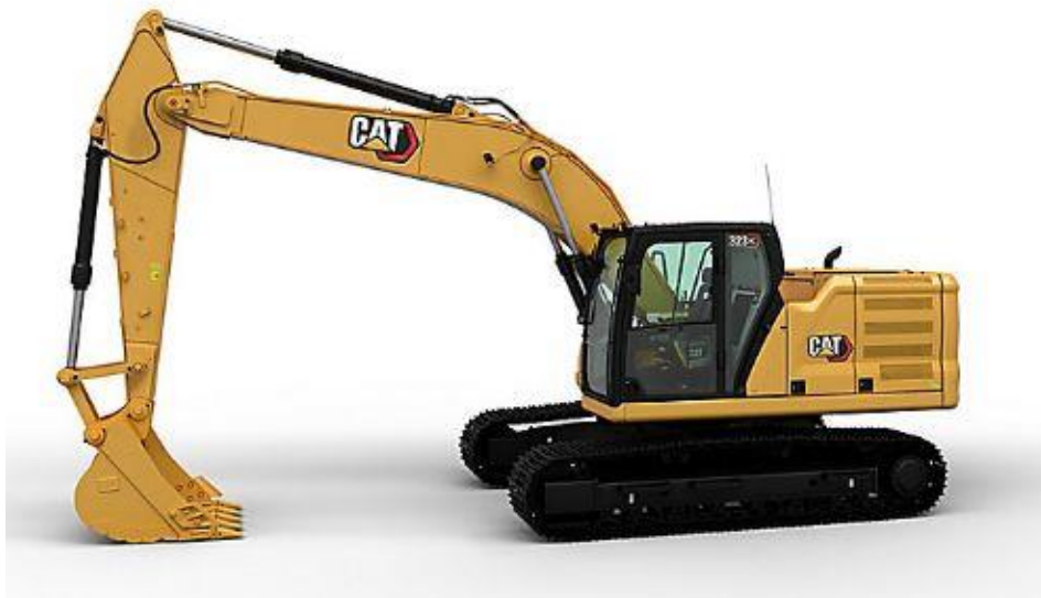
Slika 4.2. Jaružalo s dubinskom lopatom CAT 323 GC [5]
