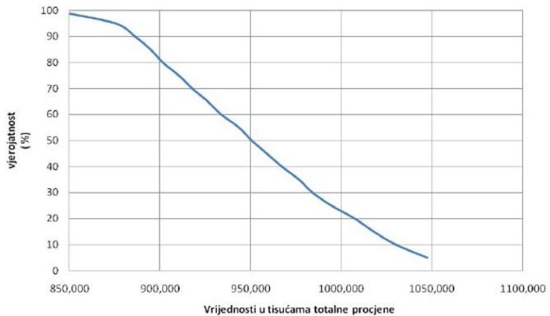
Slika 10. Prikaz rezultata simulacije procjene izgradnje objekta
