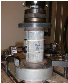
Slika 2.2 – Testiranje uzorka betona
