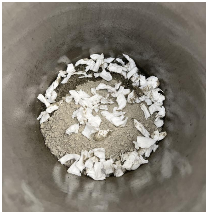
Slika 5.7.3. Sastojci spremni za miješanje
