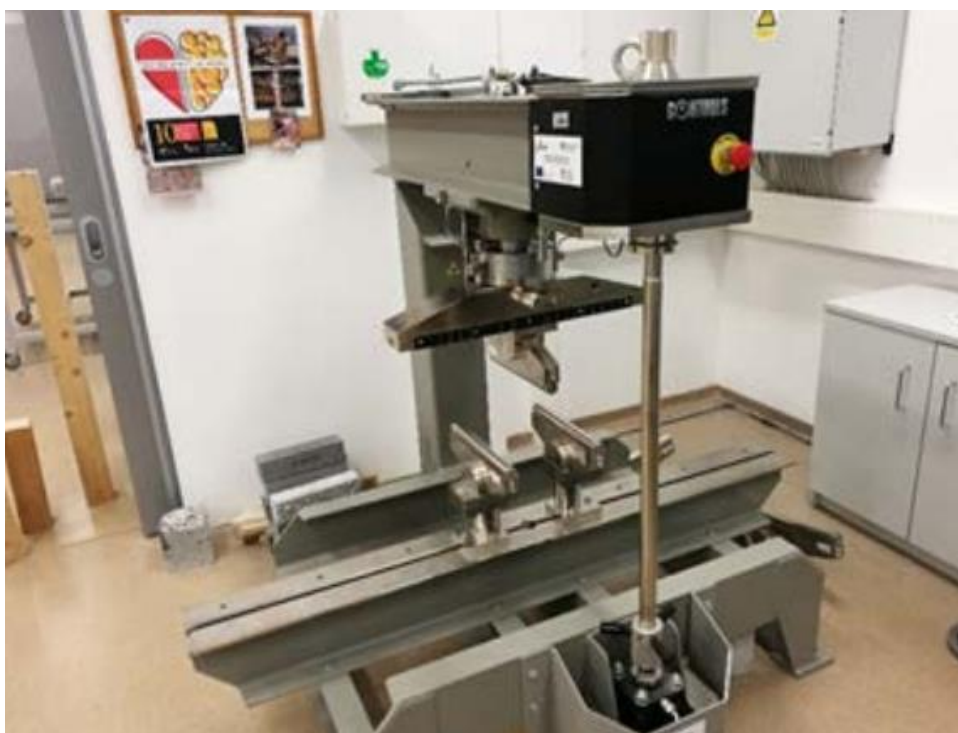
Slika 5.8.1. Okvir za ispitivanje savojne čvrstoće [27]
