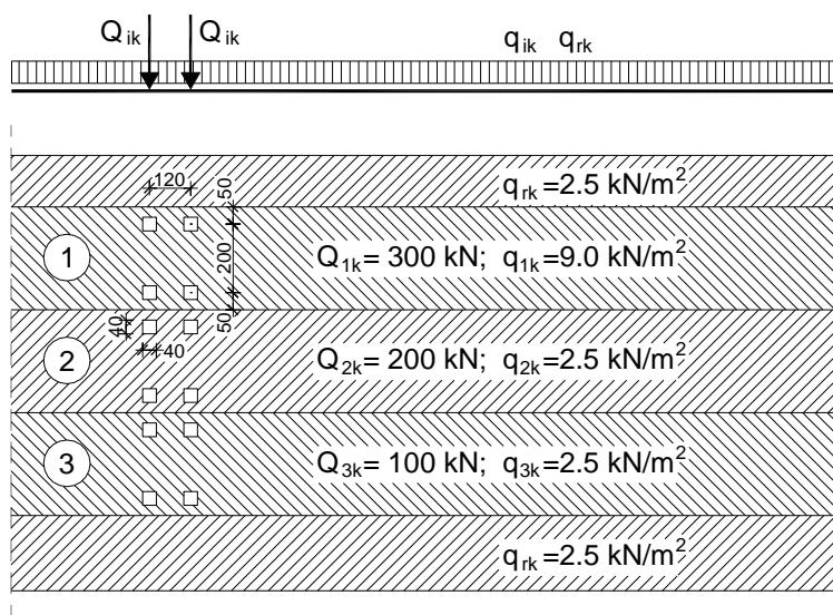
Slika 12. Prikaz načina opterećivanja mosta pokretnim opterećenje
