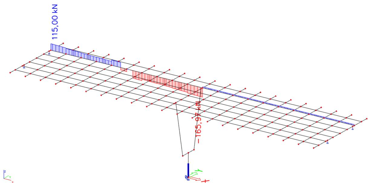
Slika 17. Pokretno – maksimalni moment u prvom polju – poprečne sile ( $Vz$ ) u  $\text{kN}$
