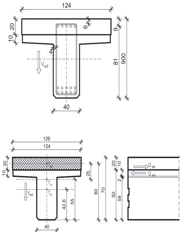
Slika 31. Poprečni presjek spregnutog T nosača
