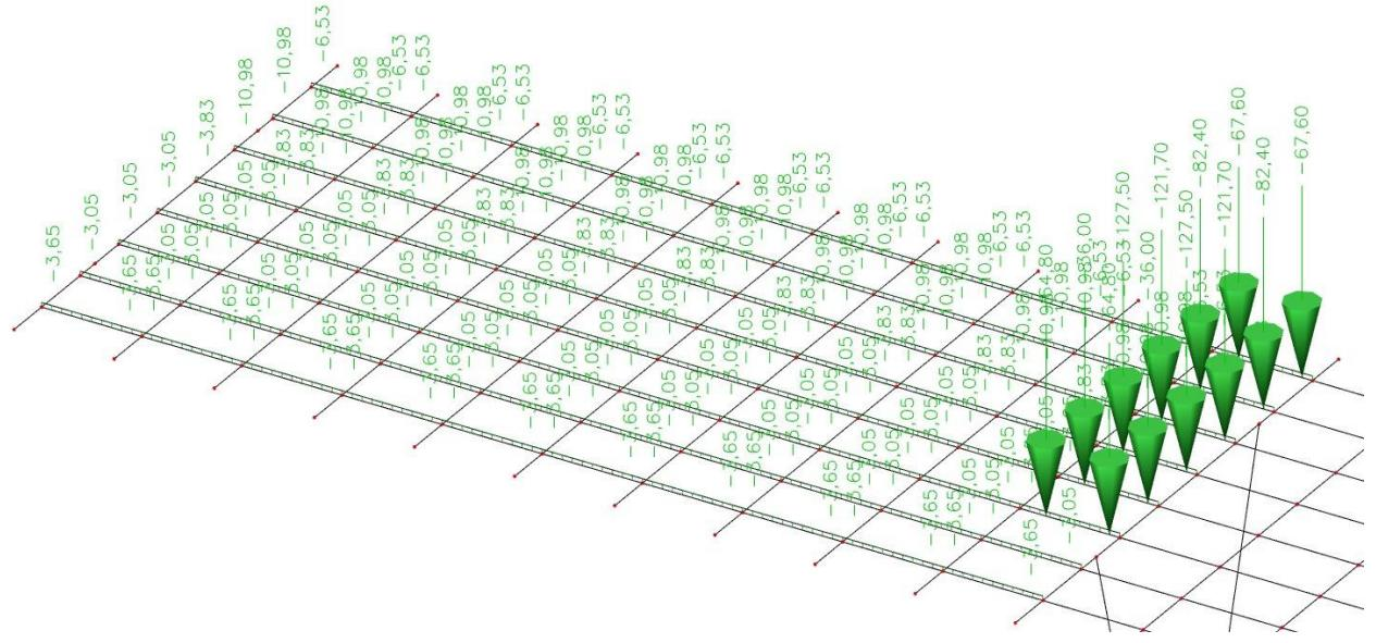
Slika 27: Pokretno opterećenje za maksimalnu poprečnu силу при ступу
