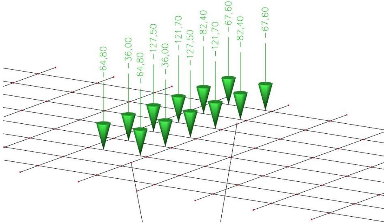
Slika 28: Prikaz tipskog vozila za maksimalnu poprečnu силу при ступу
