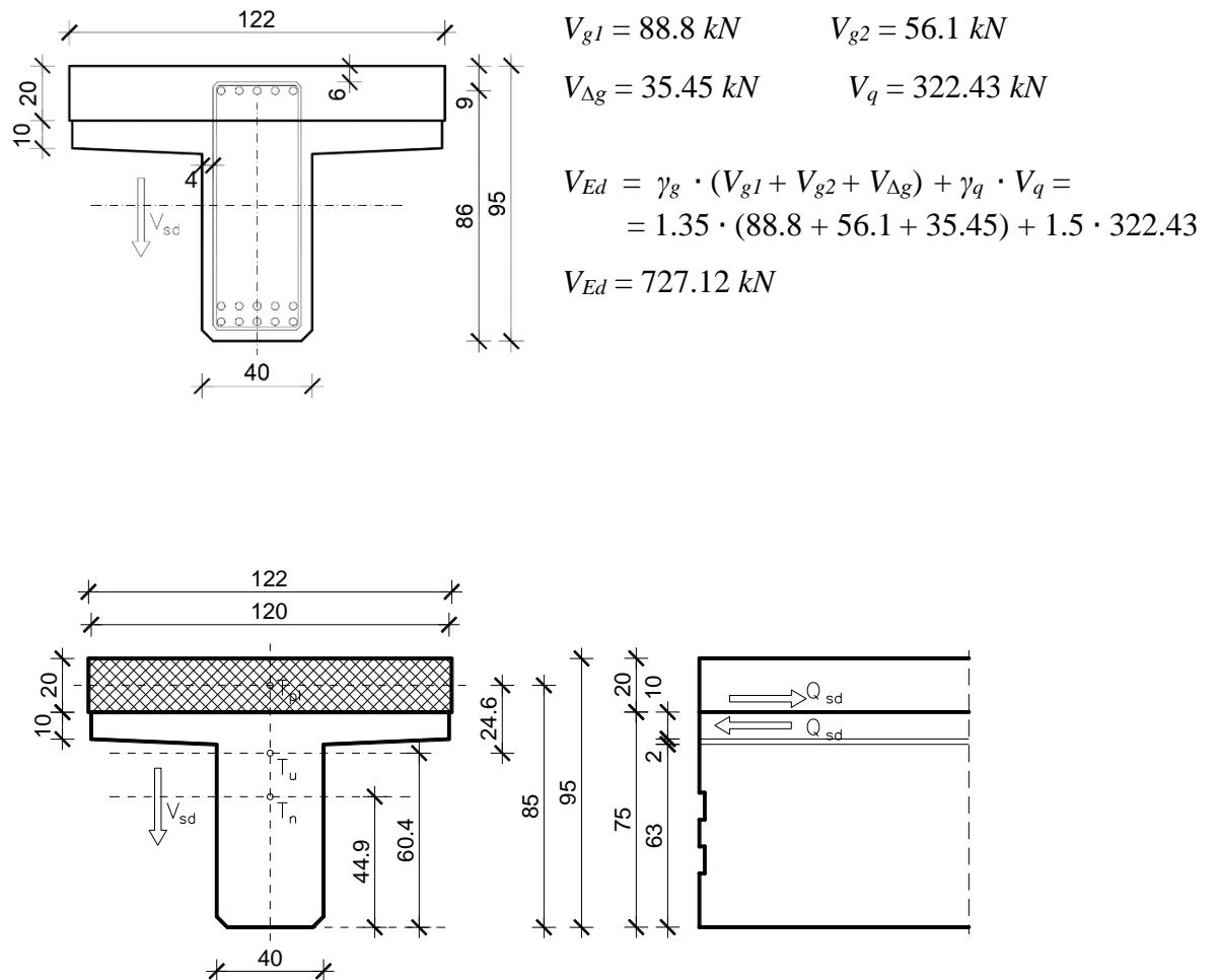
Slika 32: Poprečni presjek spregnutog T nosača
